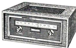
TUNER FM extrêmement sensible à large bande passante gamme de fréquences standard 87 à 101 MHz. Impédance d'entrée : 75 Ω. Sensibilité : 1 mV. Alimentation : tous secteurs. Alternatif 110 à 245 volts. Bande passante : 300 kHz • 3 étages MF. Sortie prévue pour « STEREO » Multiplex. Élégant coffret 2 tons. Dimensions : 310 x 220 x 150 mm.
