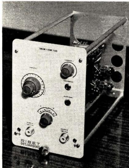
peut atteindre 5 mV/cm avec la bande passante réduite à 8 MHz, et 1 mV/cm si l'on se contente de 700 kHz. Une base de temps, extrêmement complète, avec possibilités très étendues, permet d'adapter les conditions de balayage à la nature du phénomène examiné et d'ajuster la vitesse entre 50 ns/cm et 2 s/cm. Le tube cathodique est un 125 mm avec une post-accelération de 10 kV.
