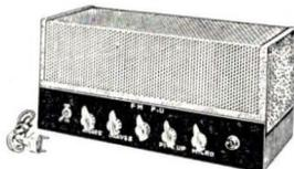
ENTREE PU et MICRO avec possibilité de mixage. DISPOSITIF de dosage « graves », « aigus ». POSITION SPECIALE F.M. ETAGE FINAL PUSH-PULL ultra-linéaire à contre-réaction d'écran.
