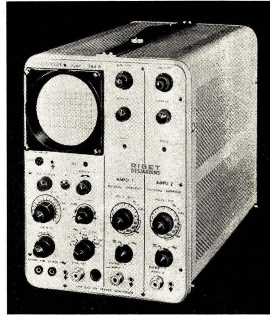
tical et l'horizontal, employer un tiroir base de temps du type courant, avec une vitesse de balayage maximale de  $0,1 \mu\text{s}/\text{cm}$ , observer deux signaux simultanément avec le tiroir amplificateur à double trace, etc.
