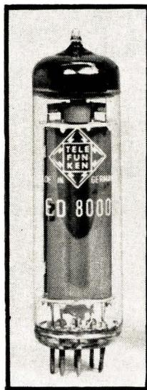
Cette triode a été plus spécialement conçue pour les stabilisateurs électroniques, mais il est évident qu'on peut lui trouver d'autres domaines d'application. Elle est munie d'une embase Noval et sa hauteur est de 82 à 83 mm (y compris les broches), avec un diamètre de 22 mm. Chauffée sous 6,3 V, elle consomme 1 A au filament. Avec une tension anodique de 100 V et une polarisation de grille de -12,5 V, elle a un courant anodique de 150 mA, une
