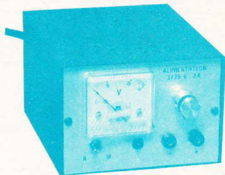
Photo 3. — Présentation générale de l'alimentation en coffret ESM.
