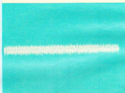
A. A vide, le bruit résiduel ne dépasse pas 500 \mu V crête à crête.
