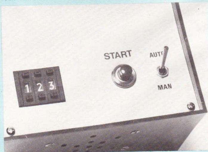
Photo 4. – Aspect de la face avant avec gros plan sur la roue codeuse.
