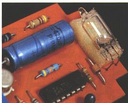
Photo 4. - Gros plan sur le contacteur mercure.
