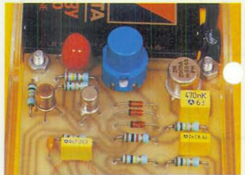
Photo 3. - On aperçoit le bouton poussoir à contact travail.
