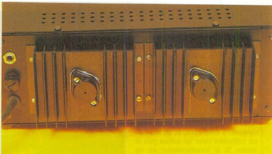
Photo 6. - Protection des transistors de sortie.
