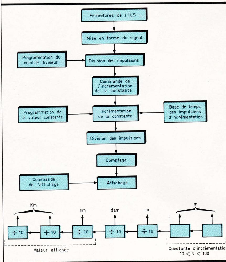
sont montés dans le plan défini par les rayons. Ces aimants défilent devant un « ILS » fixe (interrupteur à lames souples) qui se ferme sous l'action des lignes magnétiques émises par les aimants, à chacun de leur passage.
