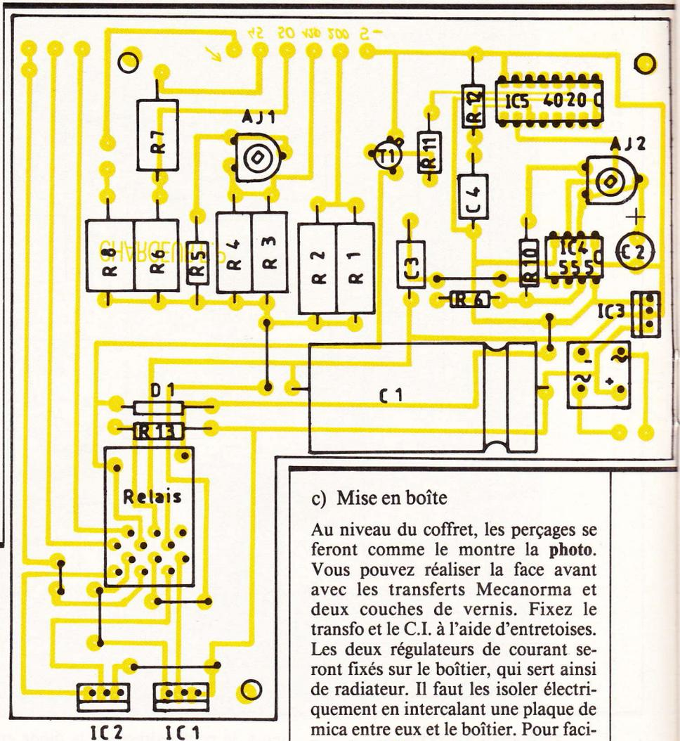
Tracé du circuit imprimé et implantation des éléments.
