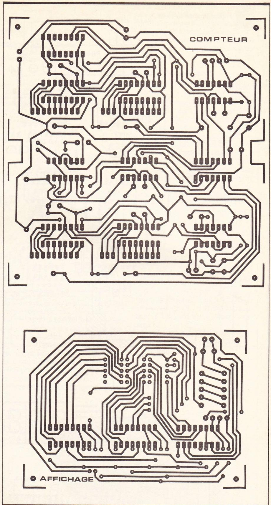
Fig. 8 Tracés des circuits imprimés à l'échelle.
