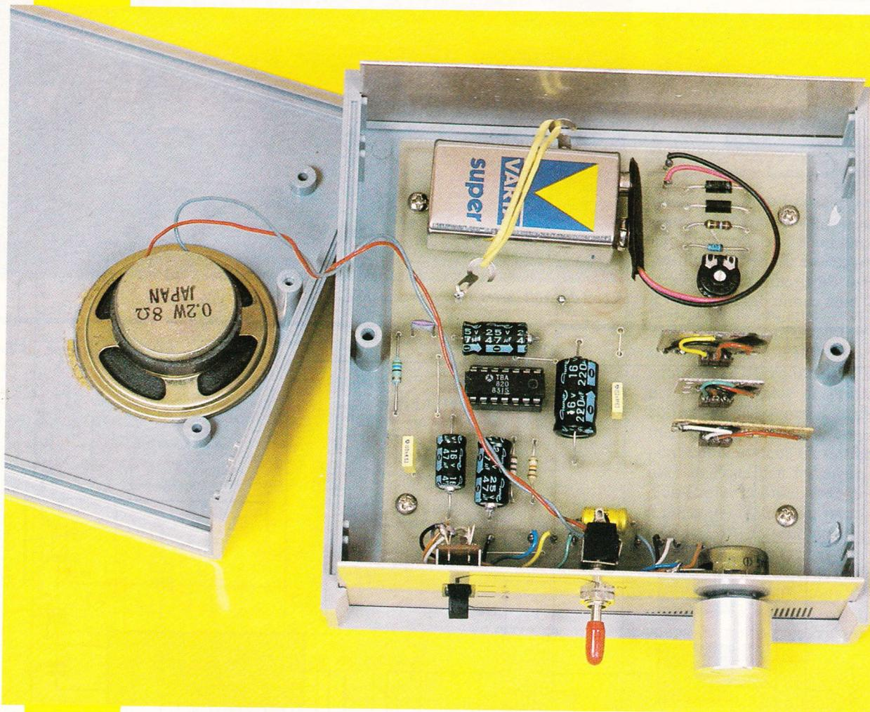
**A**vec un petit circuit amplificateur et en remplaçant le buzzer par un haut-parleur, il est très aisé de réaliser une petite attente musicale pour vos correspondants au téléphone, par exemple.
