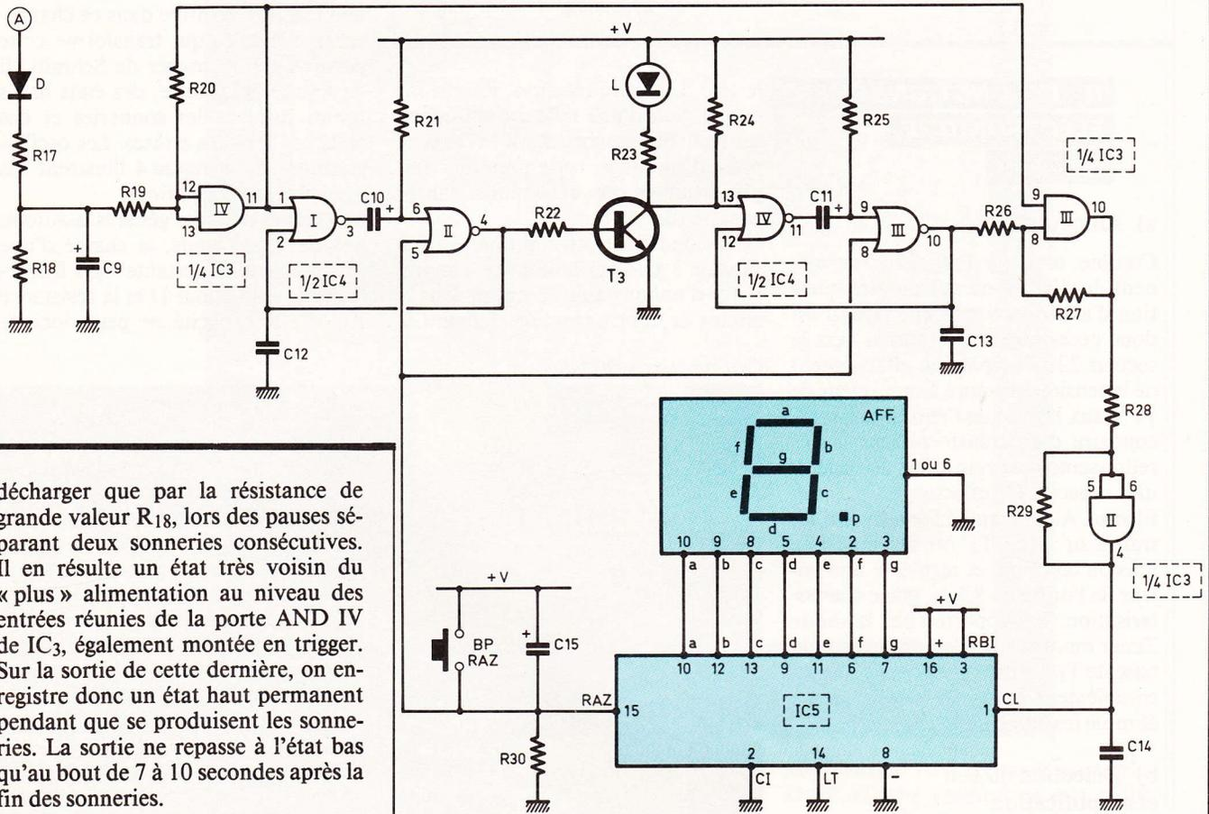
décharger que par la résistance de grande valeur  $R_{18}$ , lors des pauses séparant deux sonneries consécutives. Il en résulte un état très voisin du « plus » alimentation au niveau des entrées réunies de la porte AND IV de  $IC_3$ , également montée en trigger. Sur la sortie de cette dernière, on enregistre donc un état haut permanent pendant que se produisent les sonneries. La sortie ne repasse à l'état bas qu'au bout de 7 à 10 secondes après la fin des sonneries.
