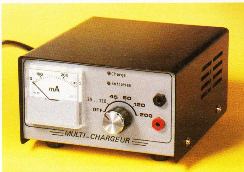
transfo préconisé (24 V-15 VA), on aura aux bornes de  $C_1$  :  $U = 24 \times \sqrt{2} \approx 34$  V, ce qui s'explique par le lissage de la tension en sortie du redresseur (fig. 2).
