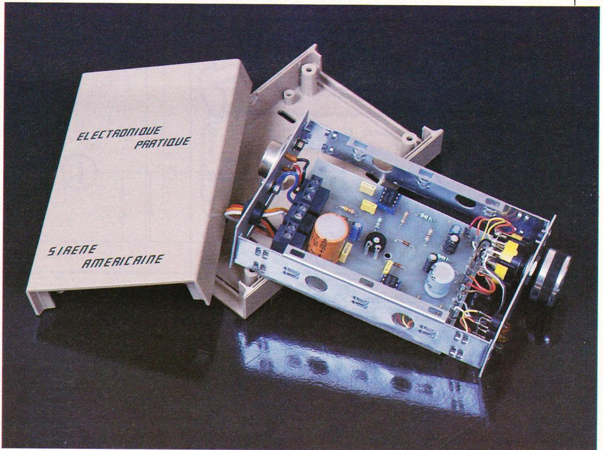
**L**a maquette offre le choix entre une modulation lente et une modulation rapide. L'ensemble est réalisé avec des composants classiques. De plus, aucun appareil de mesure n'est nécessaire pour sa réalisation, la maquette devant fonctionner dès la mise sous tension. Ce montage sera donc à la portée de tout amateur débutant, vu sa relative simplicité.
