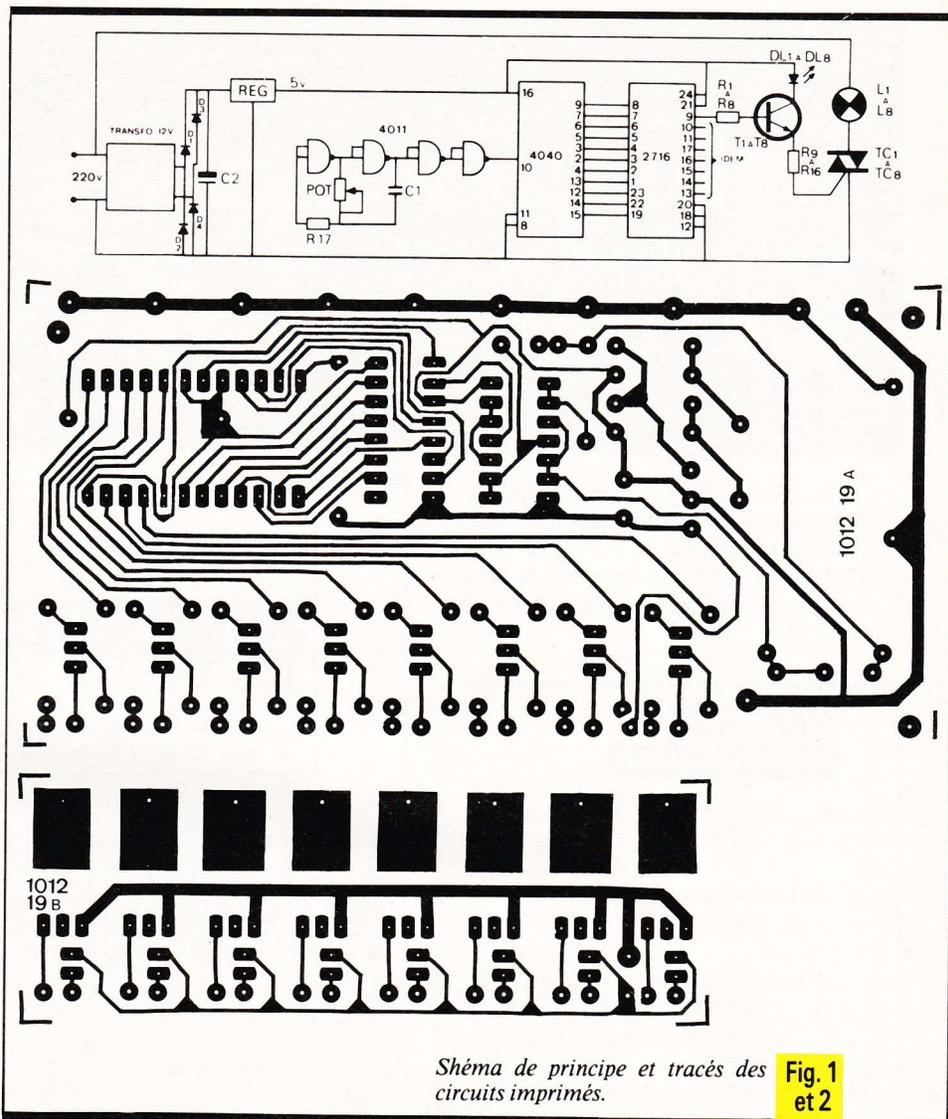
Shéma de principe et tracés des circuits imprimés.
