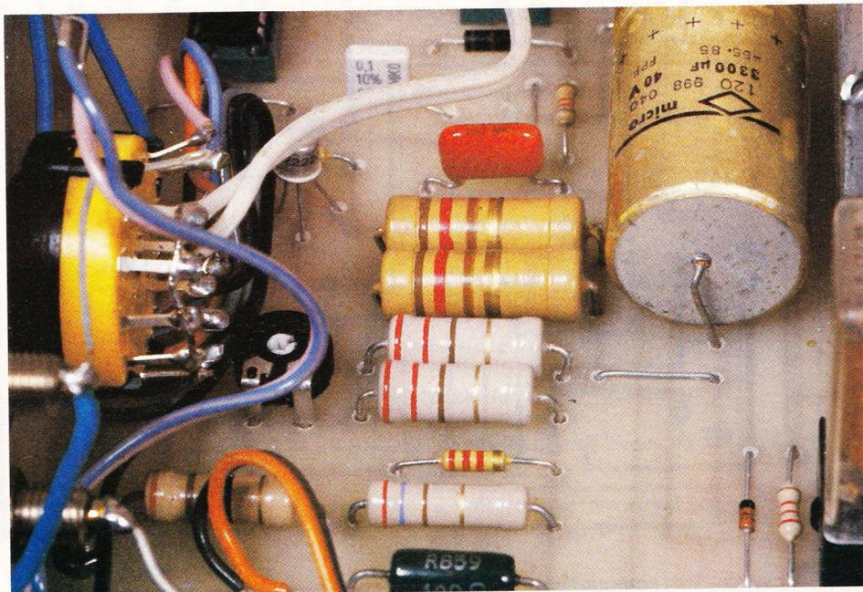
Vérifiez le sens des composants polarisés. Si tout est bon, vous pouvez brancher. Si, au bout de quelques secondes, rien ne chauffe \* ou n'explose (!), passez aux réglages.
