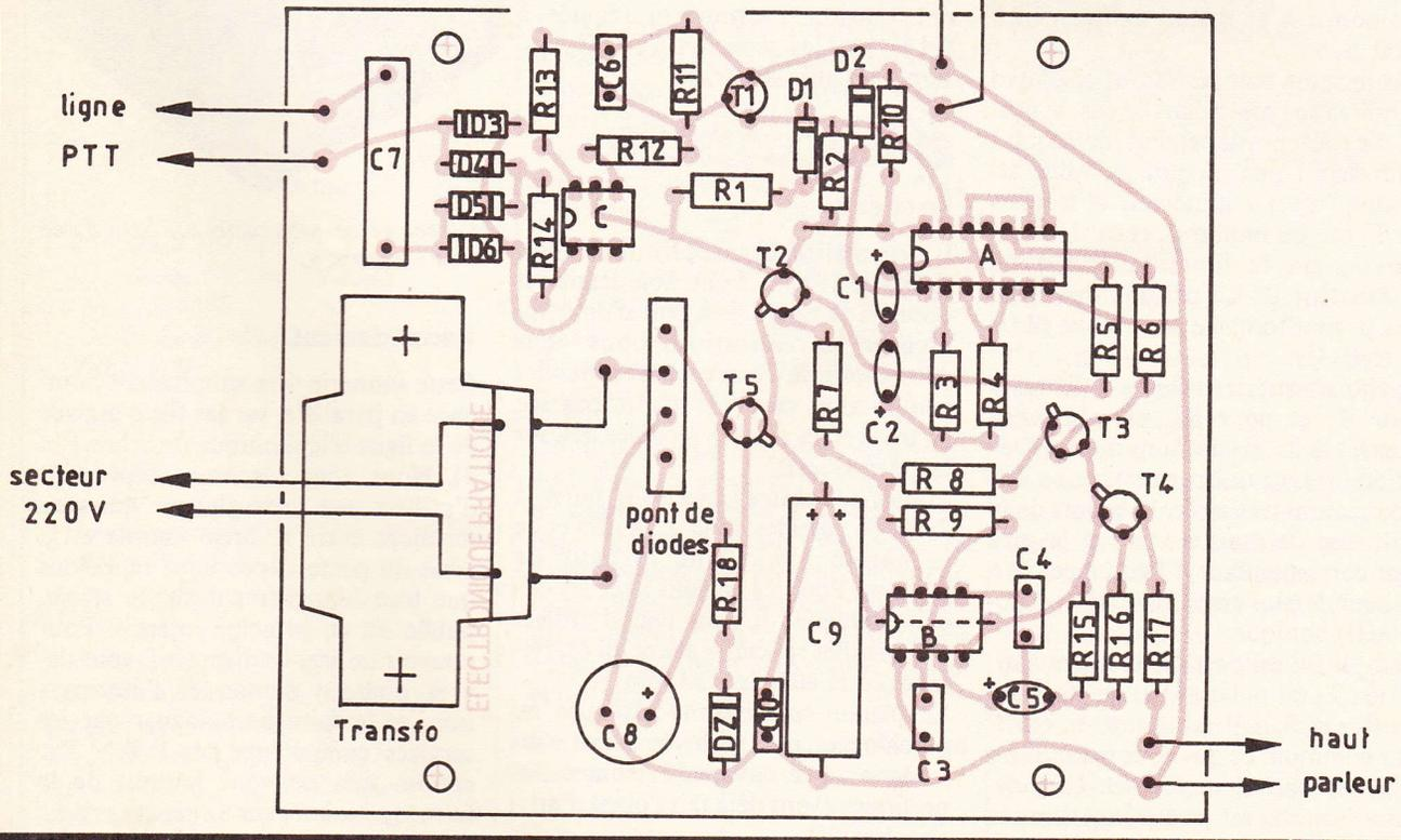
tension alternative va être appliquée au condensateur  $C_7$  et au pont formé par les diodes  $D_3$  à  $D_6$ . Le signal redressé obtenu est ensuite dirigé vers la diode électroluminescente conte-
