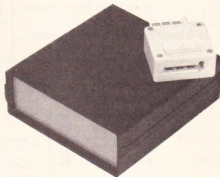
Le boîtier se raccordera à l'aide d'une prise « gigogne ».
