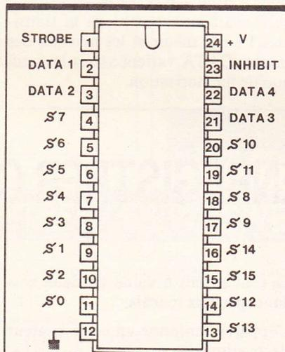
Le circuit comprend quatre entrées destinées à recevoir les informations binaires (donc de 0000 à 1111, soit seize possibilités) désignées par DATA 1 à 4. Il existe en plus une entrée STROBE (mémorisation) et une entrée INHIBIT (neutralisation). Enfin, il comporte 16 sorties repérées S<sub>0</sub> à S<sub>15</sub>, pour l'utilisation.
