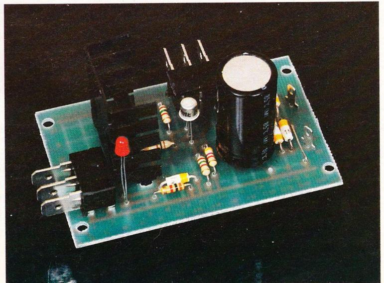
b) Montage : le repérage des composants se fait sur une grille quadrillée au pas de 2,54 mm. Les ordonnées sont repérées en a, a', b, b', c, c', d, d'... Les abscisses en 1, 2, 3, 4, 5, 6, 7, 8... Pour chaque composant, les coordonnées de ses connexions sont données dans le tableau de montage, vous permettant de le positionner à coup sûr correctement.
