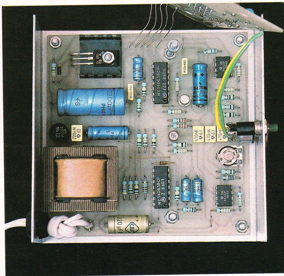
**L**e synoptique de la figure 1 indique le principe de fonctionnement du montage. Le boîtier est à disposer dans un rayon pouvant atteindre un ou deux mètres autour du téléphone. Les sonneries sont détectées par un petit micro, puis amplifiées. Il n'existe donc aucune liaison matérielle entre le montage et le télé-
