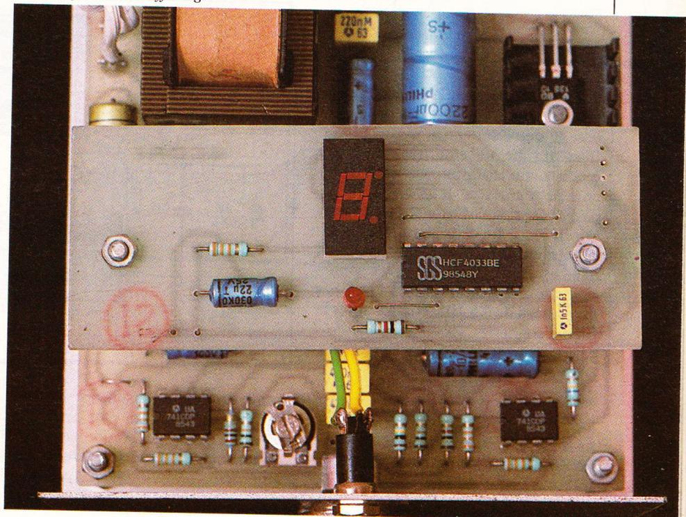
position du curseur de cet ajustable, ce gain est variable de 5 à 100. Les signaux issus de  $IC_2$  sont finalement acheminés sur la base d'un transistor PNP  $T_2$ . Ce dernier est polarisé de façon telle qu'en l'absence de signaux sur la base le collecteur présente un potentiel nul.
