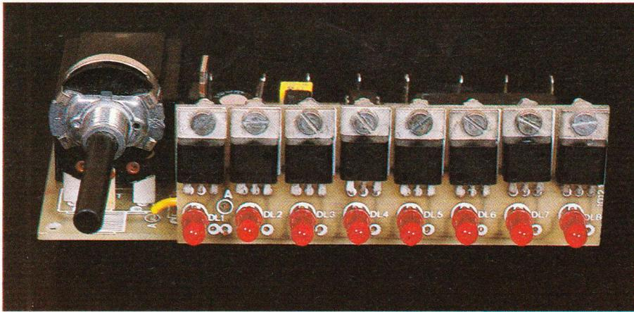
Grâce au circuit imprimé placé perpendiculairement, les diodes LED pourront être ramenées sur la face avant de l'ensemble.
