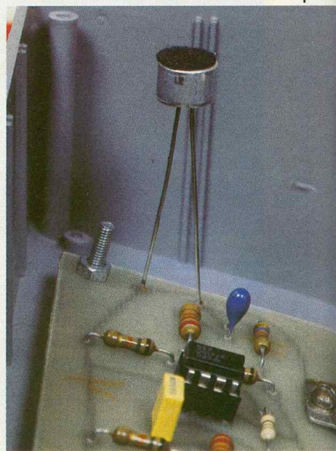
Fig. 2 Schéma de principe. Aspect du micro « électret ».
