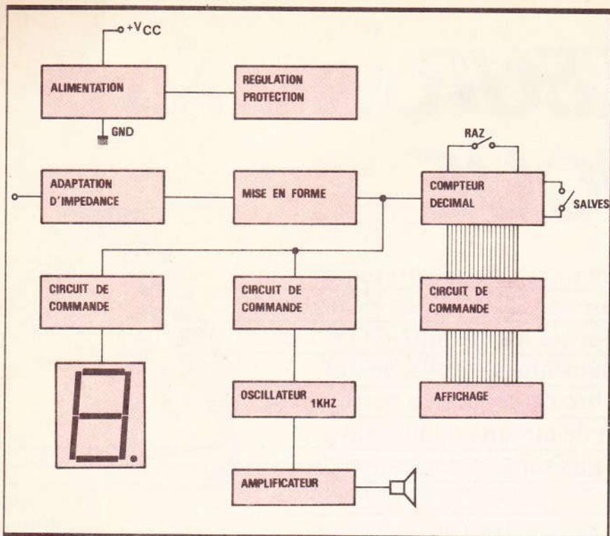
Fig. 1 Synoptique du testeur.
