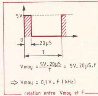
$R_5 \approx 10 \text{ k}\Omega$  ajustée à sa valeur exacte pour obtenir une impulsion de  $20 \mu\text{s}$
