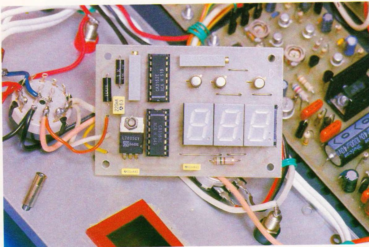
$A_{j2}$ . Le curseur de  $P_1$  en D, le courant dans  $R_5$  sera **maximal**, et le courant de court-circuit sera donc **minimal**. Quand le curseur de  $P_1$  sera en F ce sera l'inverse.
