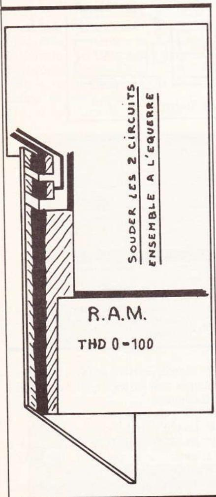
Fig.4 Disposition à l'équerre des deux circuits imprimés.
