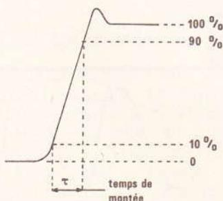
Fig. 6 et 7 Temps de montée, créneaux.
