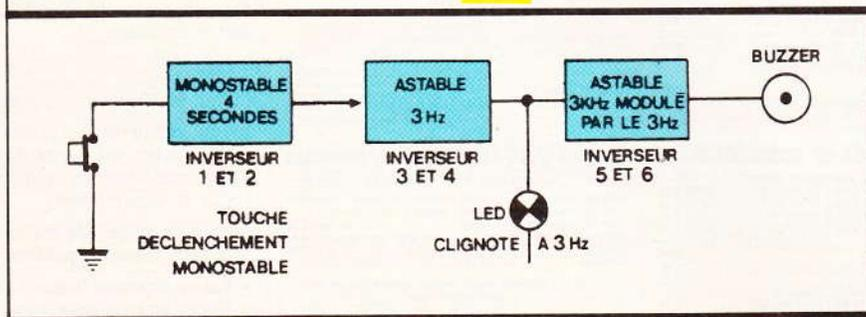
La sortie 8 de l'inverseur 2 passe donc à 0. La diode d'entrée de l'inverseur 3 n'est plus passante. L'oscillateur 1 se met donc à osciller à environ 3 Hz, autorisant l'oscillateur 2 à osciller de même, mais en le modulant à 3 Hz. La diode Led, à travers le transistor, clignotera à 3 Hz à la fréquence de l'oscillateur.
