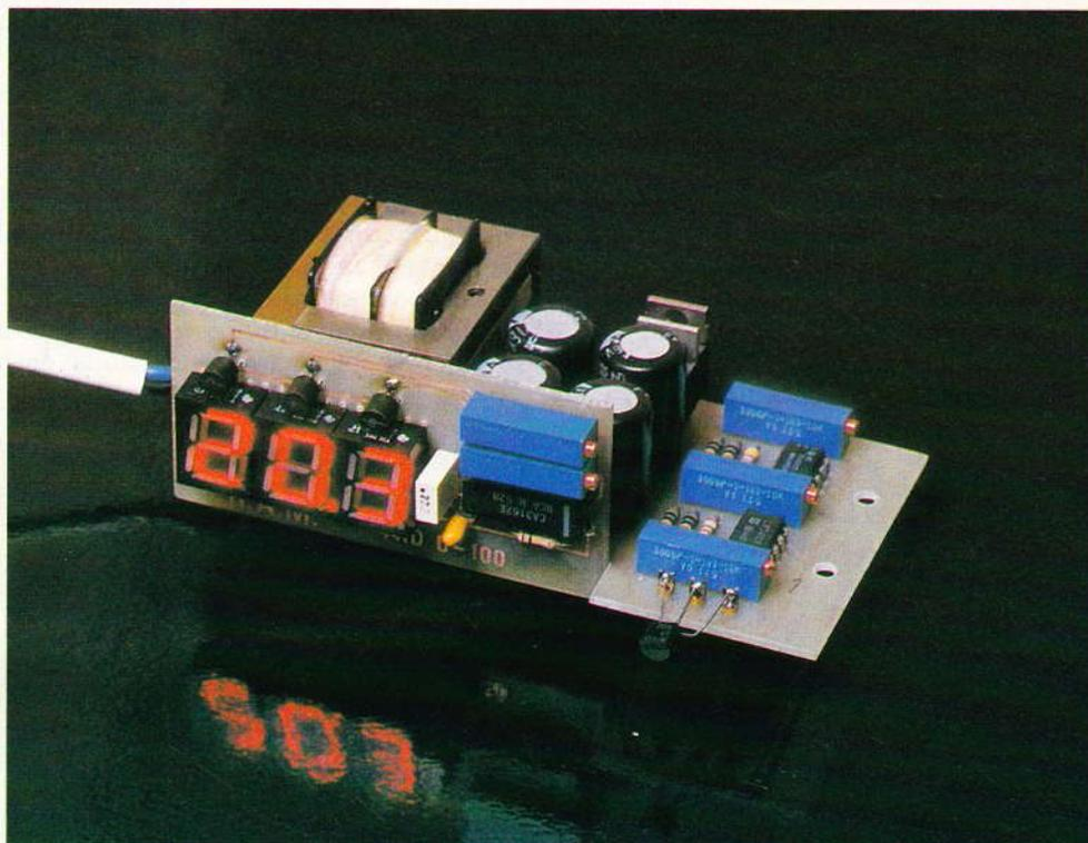
**L**a figure 1 précise le schéma de principe du montage. Le capteur, en fonction de la température, fait varier une tension entre 2,23 V pour  $-50^{\circ}\text{C}$  à 3,73 V pour  $+100^{\circ}\text{C}$ . La tension de 2,73 V équivalant à une température de  $0^{\circ}\text{C}$ .
