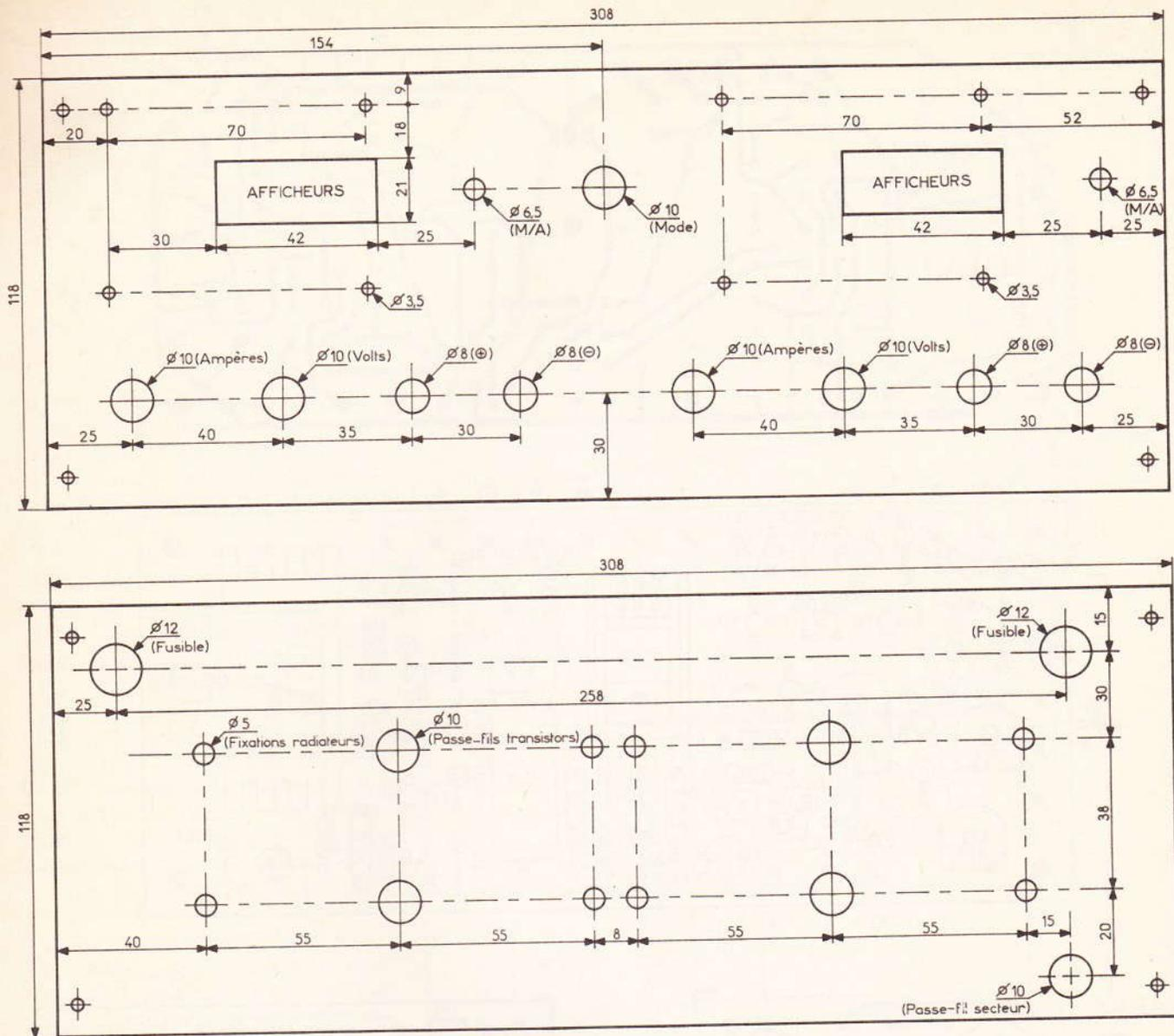
**Fig.12** Plan de perçage du coffret
