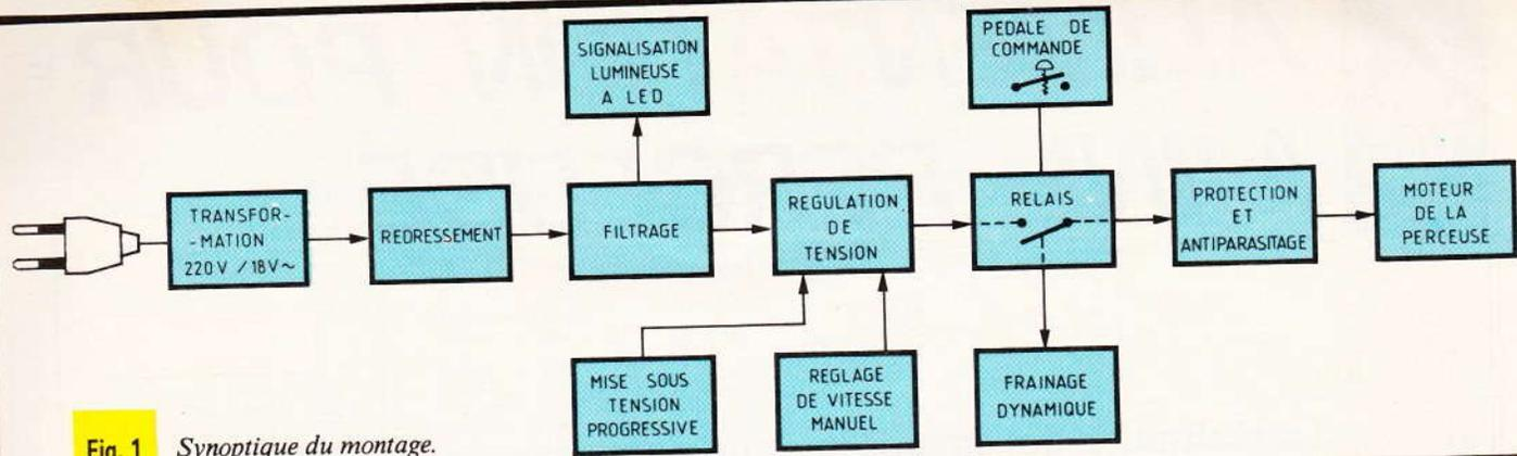
Fig. 1 Synoptique du montage.
