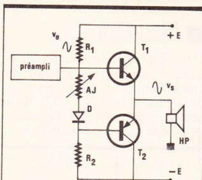
Rappelons d'abord le fonctionnement d'un étage en classe B, en nous référant au schéma, très simplifié, de la **figure 16**: il s'agit d'un push-pull dit « complémentaire », car les deux transistors de sortie,  $T_1$  et  $T_2$ , y sont de types opposés.  $T_1$  est un NPN, et  $T_2$  un PNP. Nous supposons l'ensemble alimenté sous deux tensions symétriques  $+E$  et  $-E$ , ce qui supprime la nécessité d'un condensateur de liaison vers le haut-parleur.
