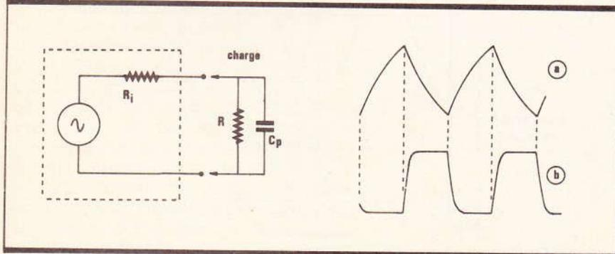
teur, donc un filtre passe-bas, et les fréquences élevées y sont atténuées. Ceci n'est guère gênant pour les sinusoïdes, dont seule varie l'amplitude. Par contre, les autres signaux (triangles, créneaux) se trouvent déformés : rampes transformées en exponentielles (fig. 10a) et temps de montée des créneaux allongés (fig. 10b). Cet effet est d'autant plus sensible, pour une valeur donnée de  $C_p$ , que  $R_i$  est plus grande.
