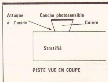
Fig. 1 Détails d'une piste vue en coupe.
