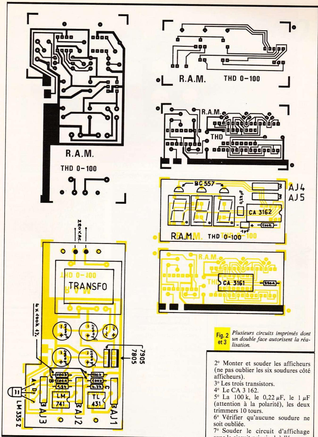
Fig. 2 Plusieurs circuits imprimés dont un double face autorisent la réalisation.
