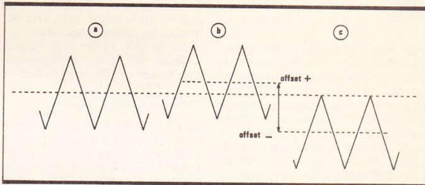
Fig. 11 La commande d'offset.
