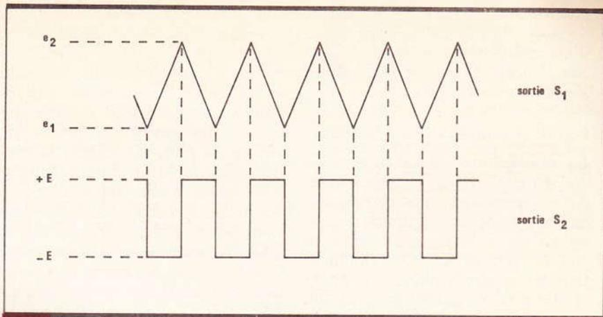
**Fig. 3** Oscillogrammes des sorties  $S_1$  et  $S_2$ .
