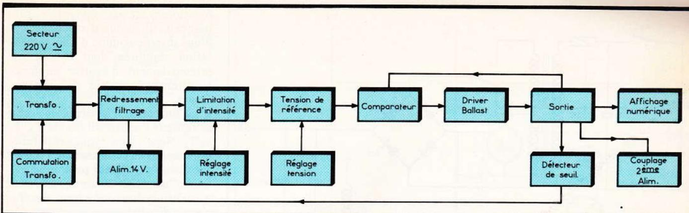
**Fig. 1** Synoptique complet de l'alimentation.
