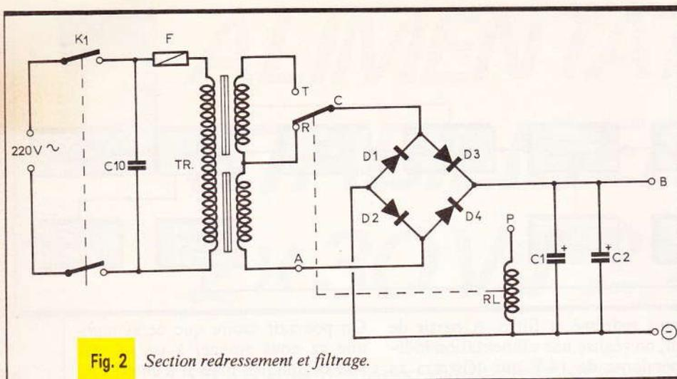
Fig. 2 Section redressement et filtrage.
