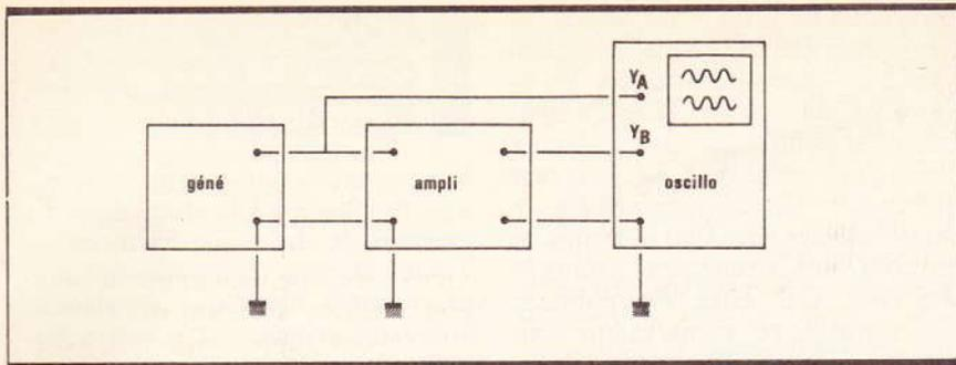
Fig. 12 Principe de mesure du gain.
