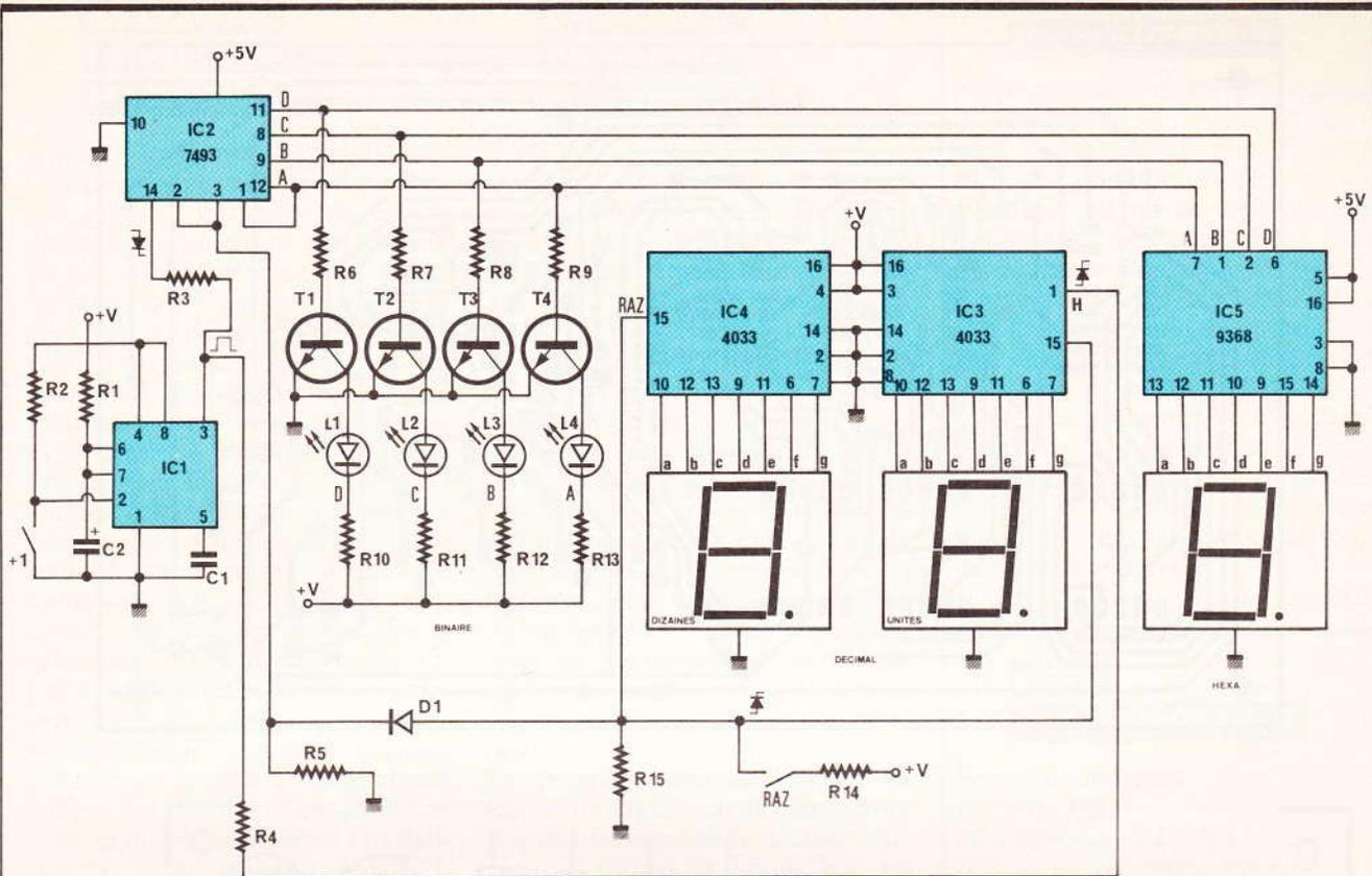
Fig. 2 Schéma de principe complet.
