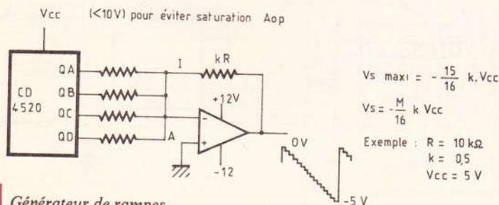
Fig. 1 Générateur de rampes.
