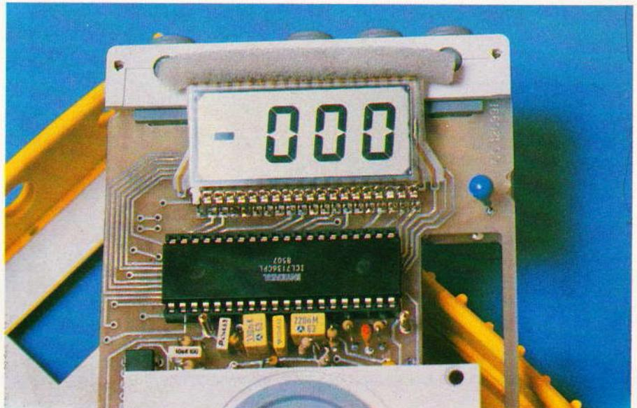
Le schéma de principe de l'appareil se construit autour du circuit intégré Intersil convertisseur analogique/numérique.
