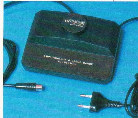
Photo 4. – Amplificateur à large bande. Il s'intercale entre l'antenne et le téléviseur.
