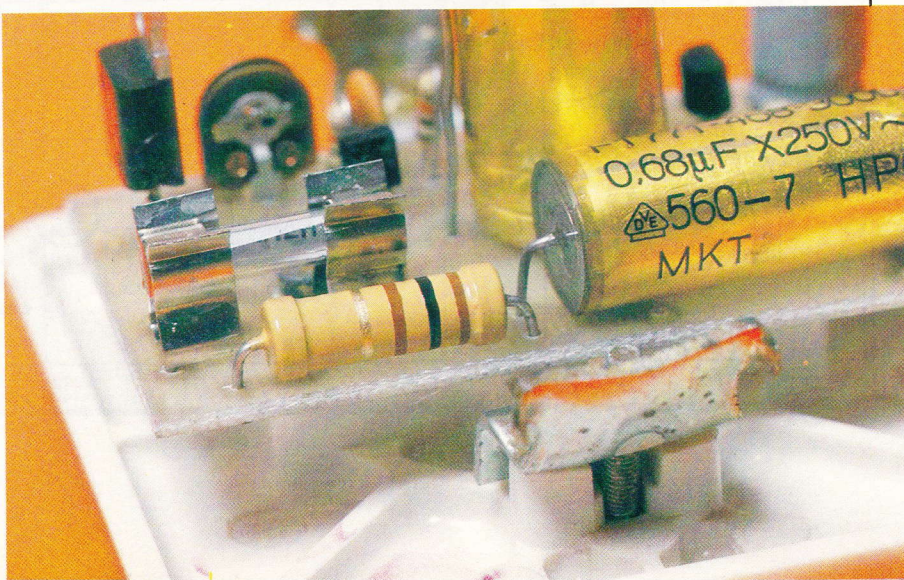
Photo 3. - La section alimentation 100 Ω/0,68 μF.
