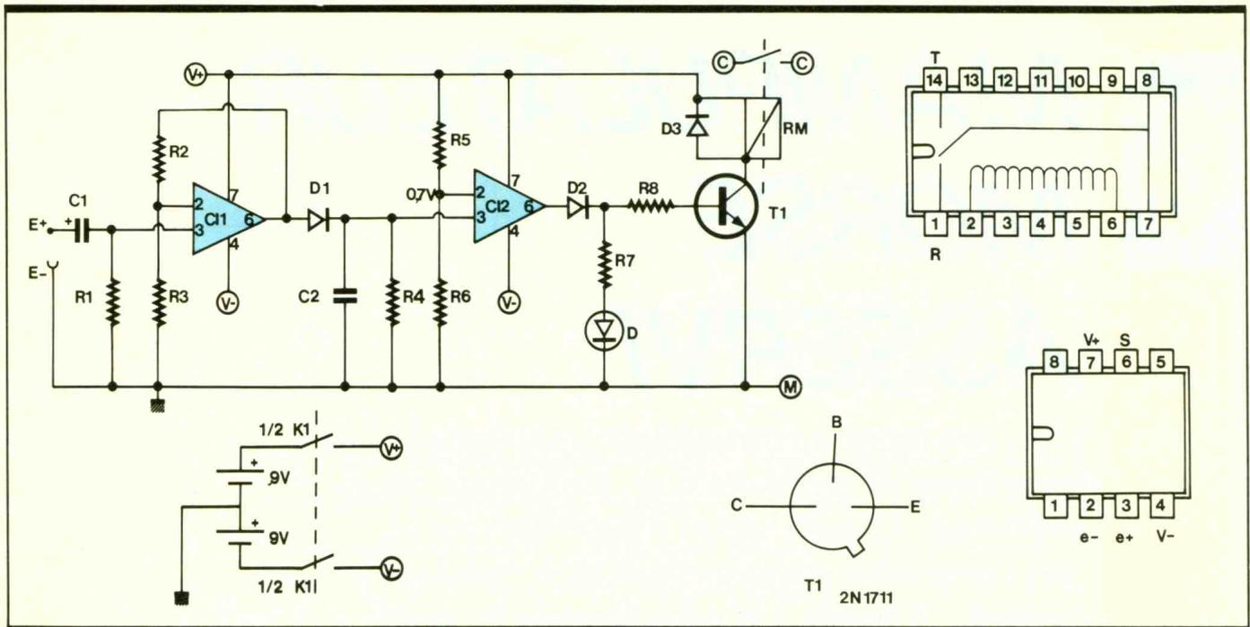
**Fig. 1** Deux 741 et un transistor suffisent pour faire coller un relais pendant la durée d'un signal sonore.
