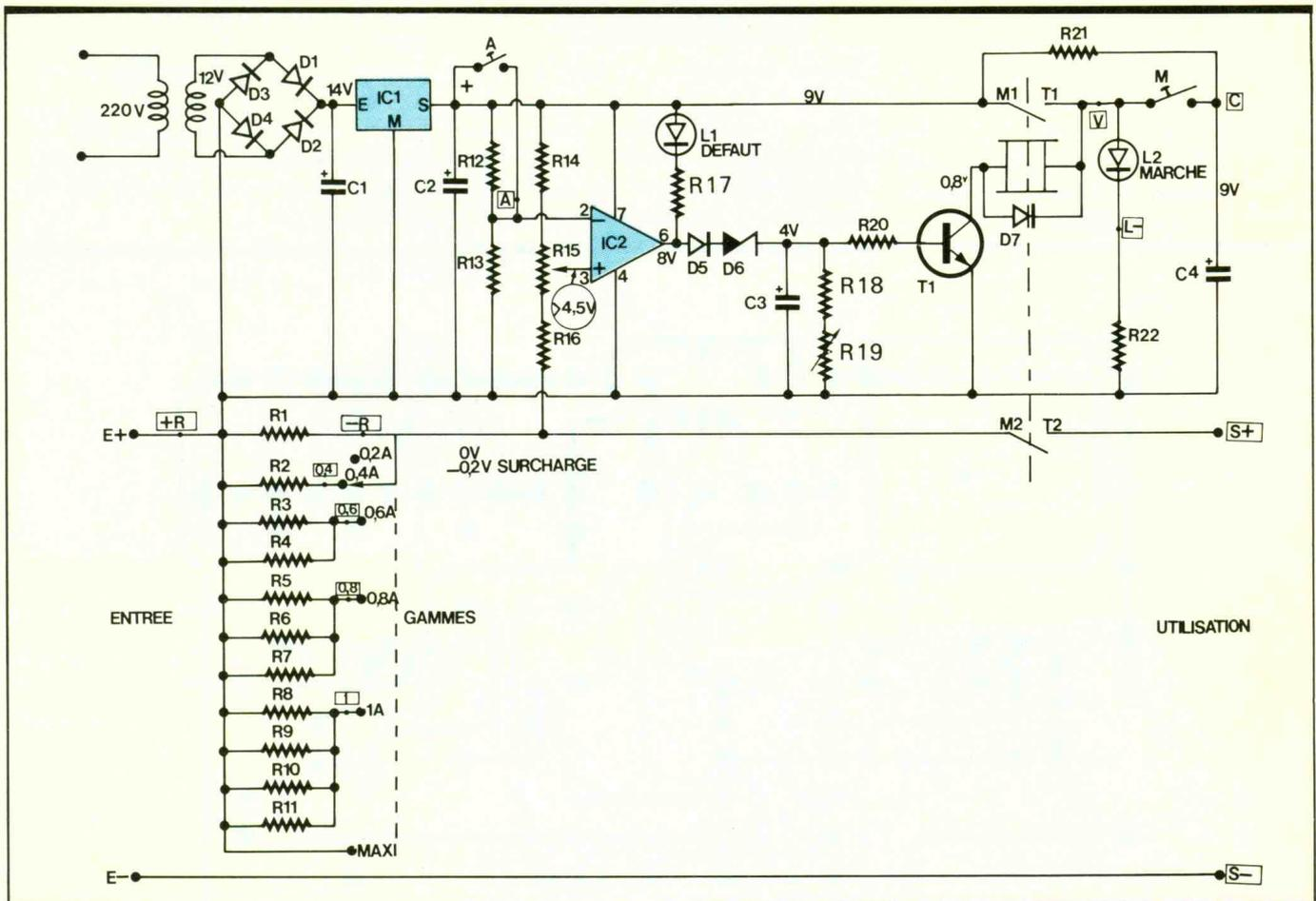
Fig. 2 Le schéma de principe fait notamment appel à un 741.
