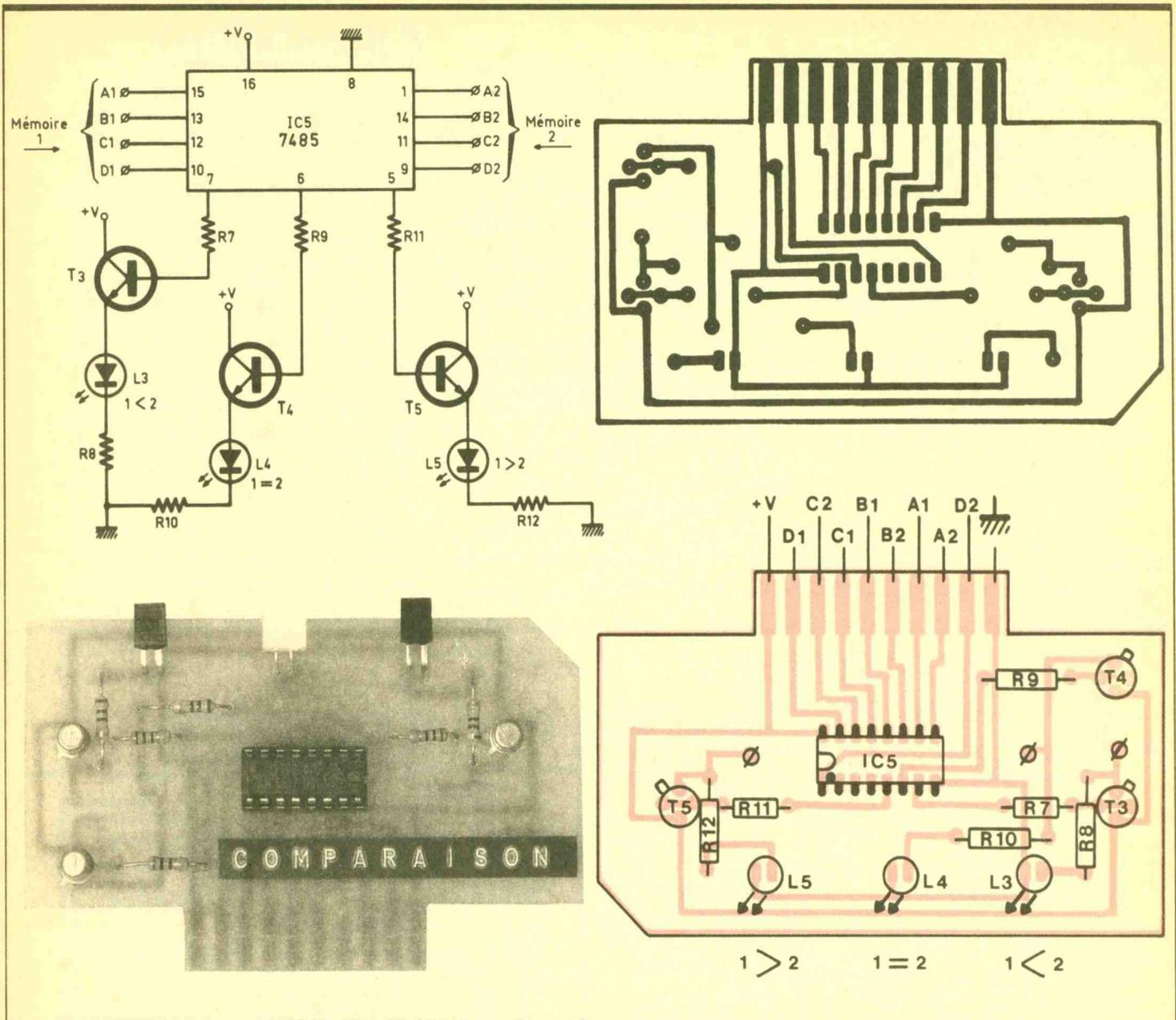
**Fig. 3** Platine de comparaison.
