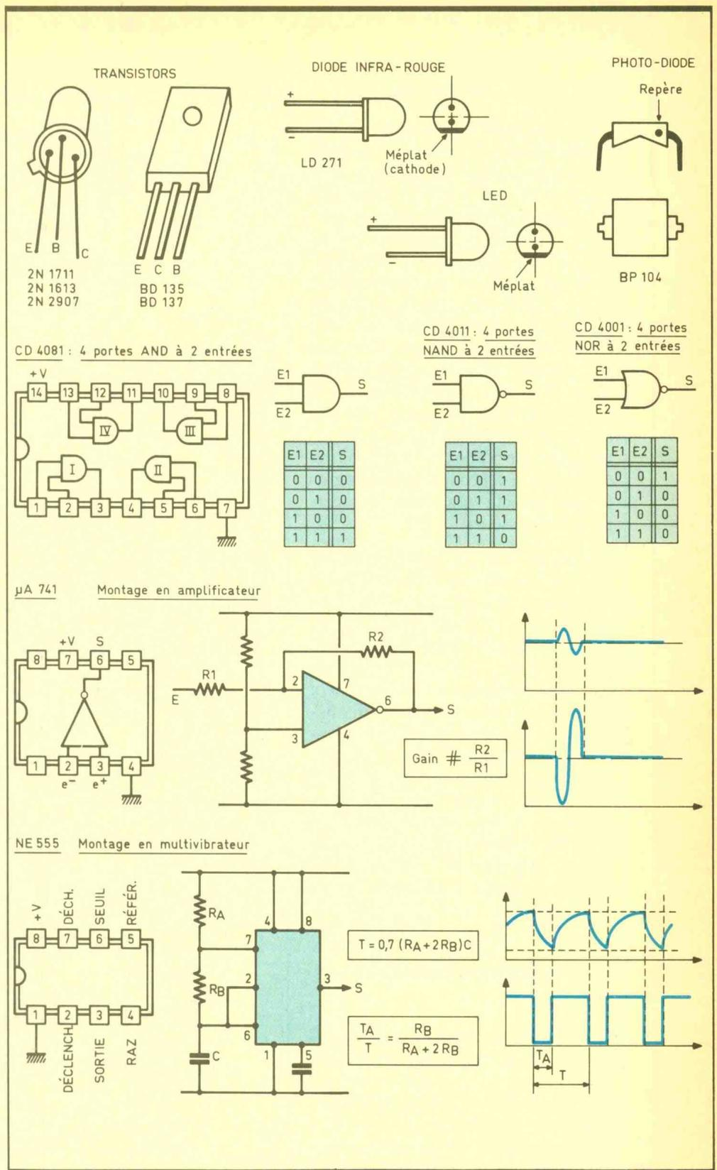
quences musicales qui se succèdent alternativement et qui sont transmises à un haut-parleur par l'intermédiaire de R<sub>53</sub> et de la capacité C<sub>32</sub>. On se reportera à la figure 7 qui rappelle le fonctionnement d'un « 555 » monté en multivibrateur. La valeur de R<sub>53</sub> peut varier de 0 à 100 Ω. Si on remplace cette résistance par un strap (0 Ω), on obtient
