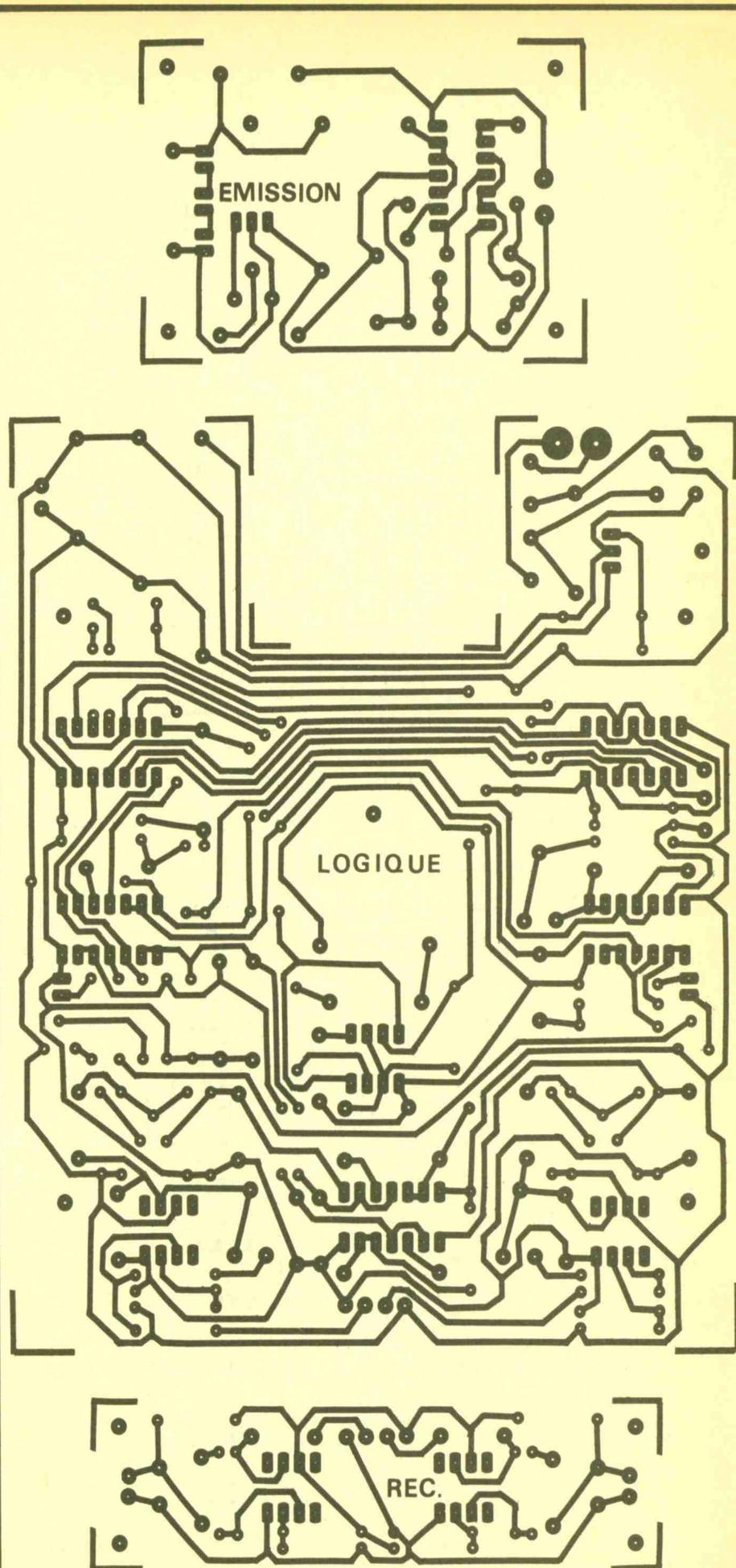
Fig. 8 Le tracé des circuits imprimés et
