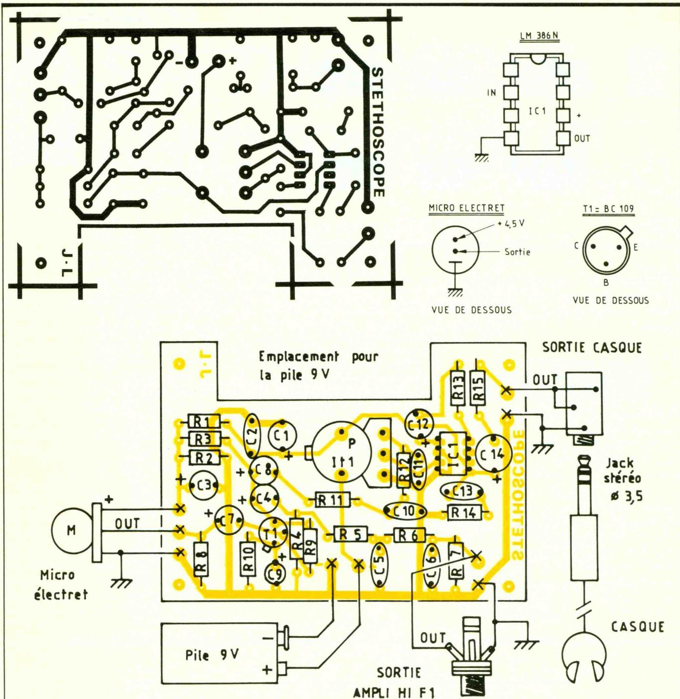
Fig. 3 Le tracé du circuit imprimé se reproduira à l'aide de transferts
