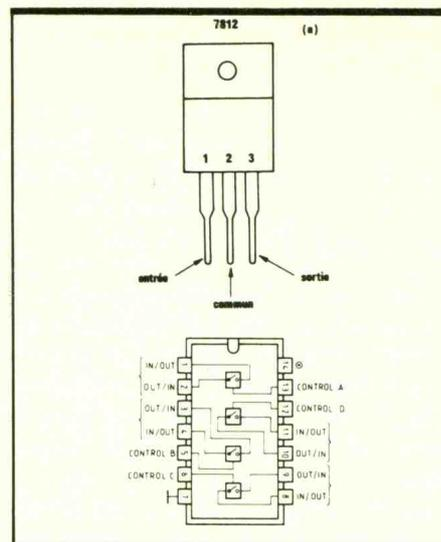
Fig. 9 Brochages du 7812 régulateur et Fig. 10 du 4016.
