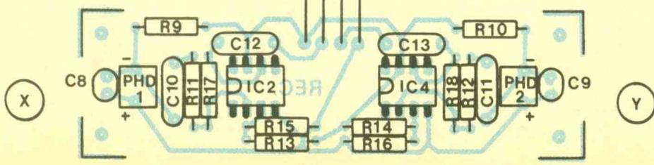
Les ajustables seront à implanter curseurs placés en position médiane. En dernier lieu, on implantera les circuits intégrés en veillant bien sûr à leur orientation correcte et en ménageant un temps de refroidissement suffisant entre deux soudures consécutives sur le même boîtier. Le haut-parleur pourra être collé directement sur la face époxy du circuit imprimé.
