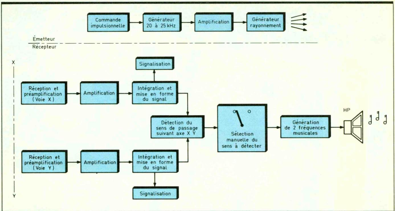
Fig. 2 *Synoptique complet du montage.*
