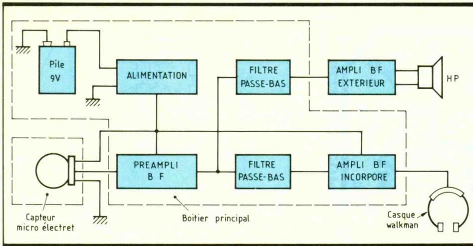
**Fig. 1** Synoptique du montage.
