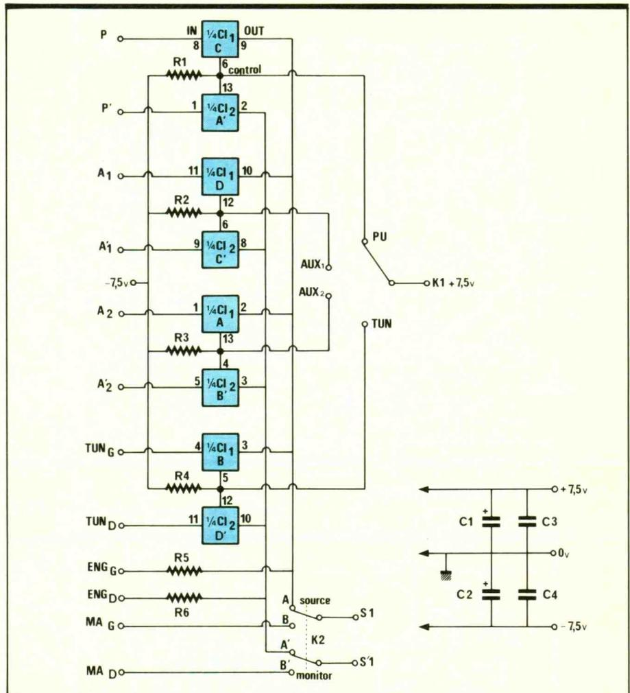
Fig. 5 Schéma de principe de la commutation d'entrée.
