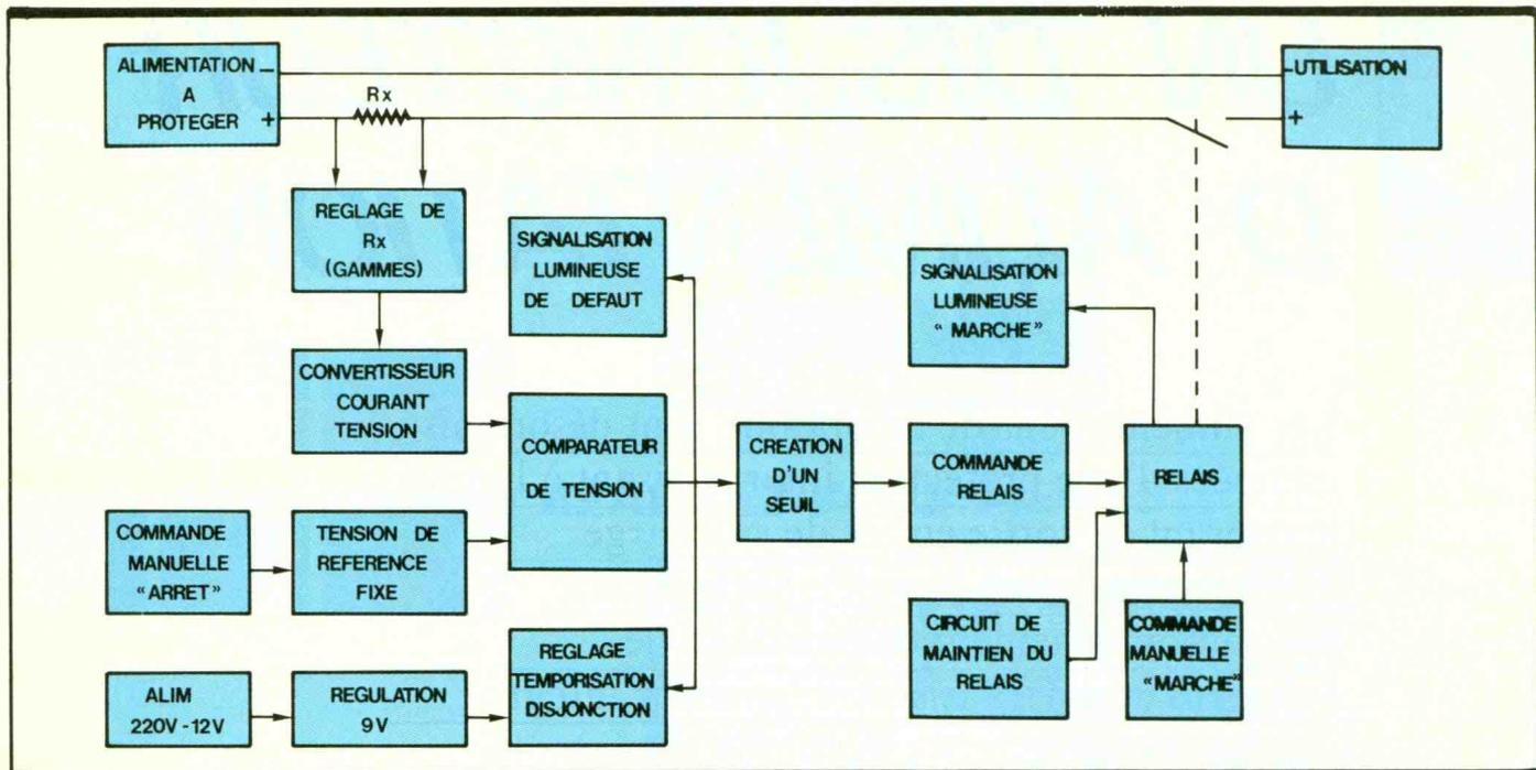
Fig. 1 Synoptique complet du disjoncteur.
