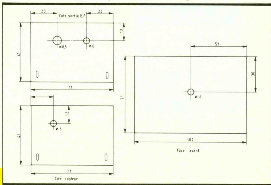
ties du boîtier. Fixer ensuite les composants extérieurs (jack Ø 3,5 stéréo femelle du capteur, jack Ø 3,5 casque et Ø 6,35 mm pour l'amplificateur extérieur).
