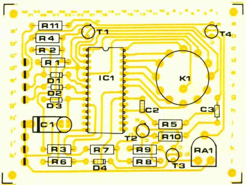
Exemple : la résistance  $R_1$  de  $1\text{ k}\Omega$  en a1/a5 indique que la résistance doit avoir une connexion soudée en a1, l'autre en a5.
