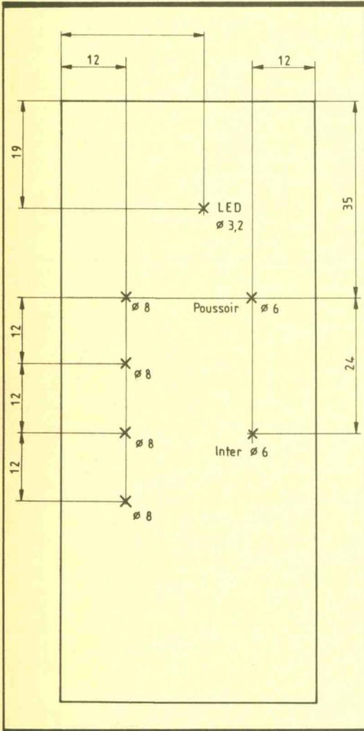
Fig. 4 Plan de perçage du coffret Retex.
