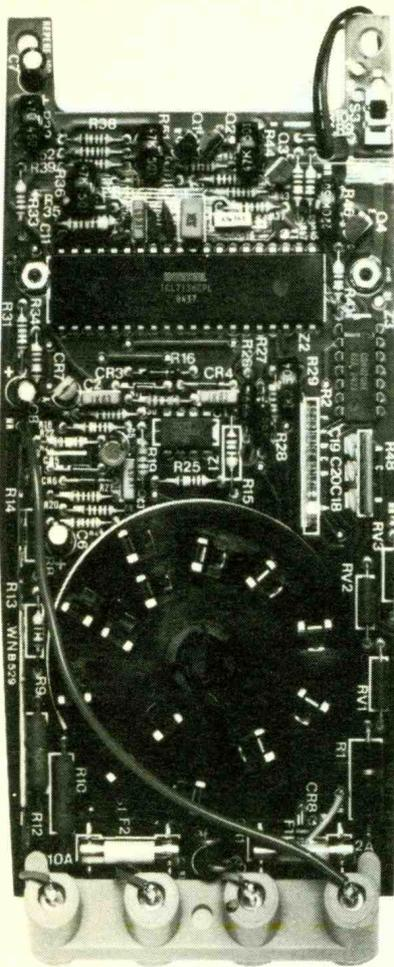
L'impédance d'entrée est de 10 MΩ en continu comme en alternatif. La chute de tension sur les intensités reste inférieure à 0,5 V dans le cas le plus défavorable. On notera également que l'appareil possède à la fois le calibre 2 A et le calibre 10 A.
