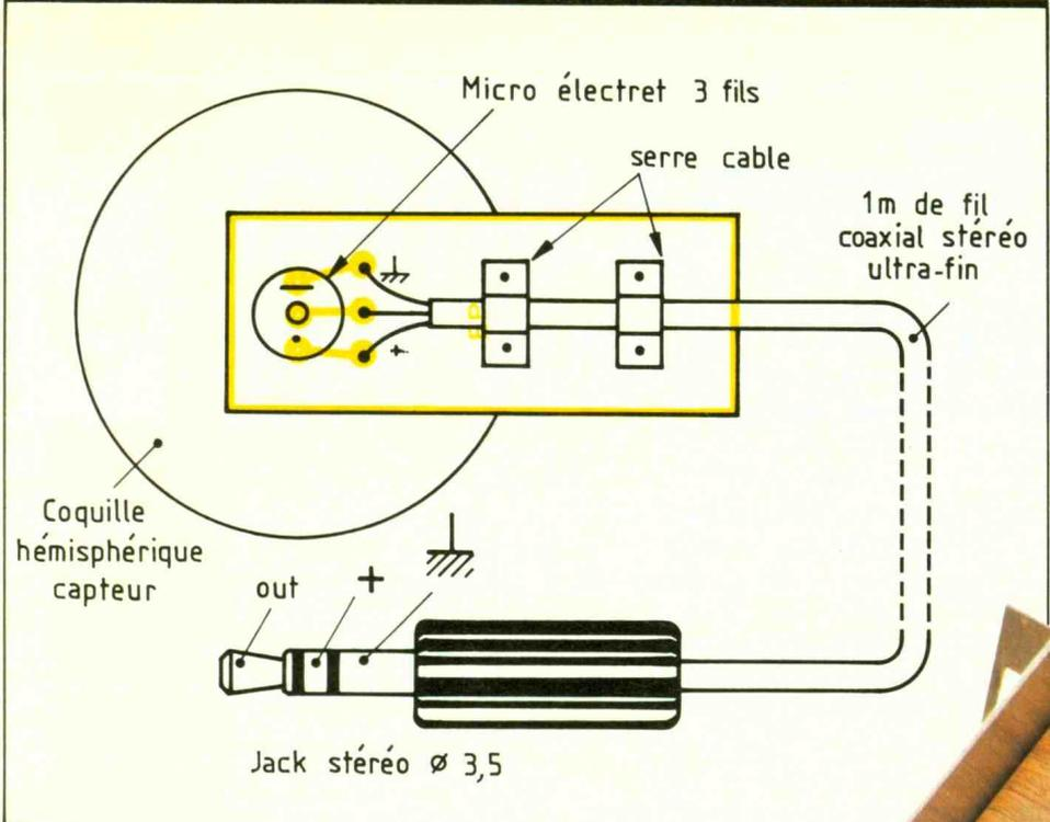
**Fig. 6** Détails de montage du capteur.
