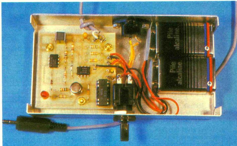
Photo 3. – Mise en place des éléments à l'intérieur du coffret.
