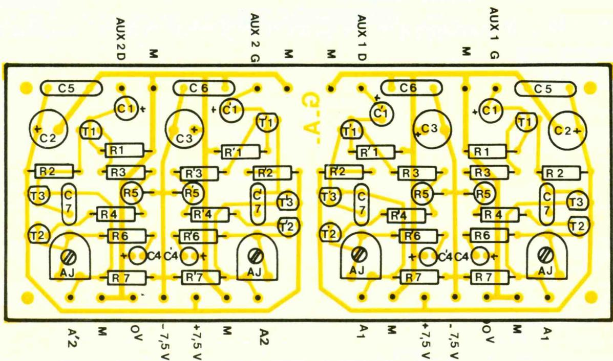
Fig. 15 Réalisation des deux préamplis
