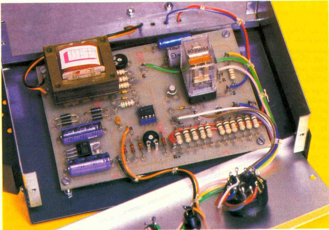
**L**a solution pour éviter ces inconvénients est bien sûr de couper le courant d'utilisation lorsque celui-ci dépasse un certain seuil. Le montage que nous vous proposons est un disjoncteur avec réglage de l'intensité maxi. En outre, le retard à la disjonction est réglable selon l'application envisagée.
