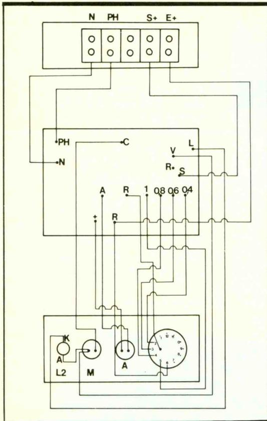
Fig. 7 Plan de câblage général.
