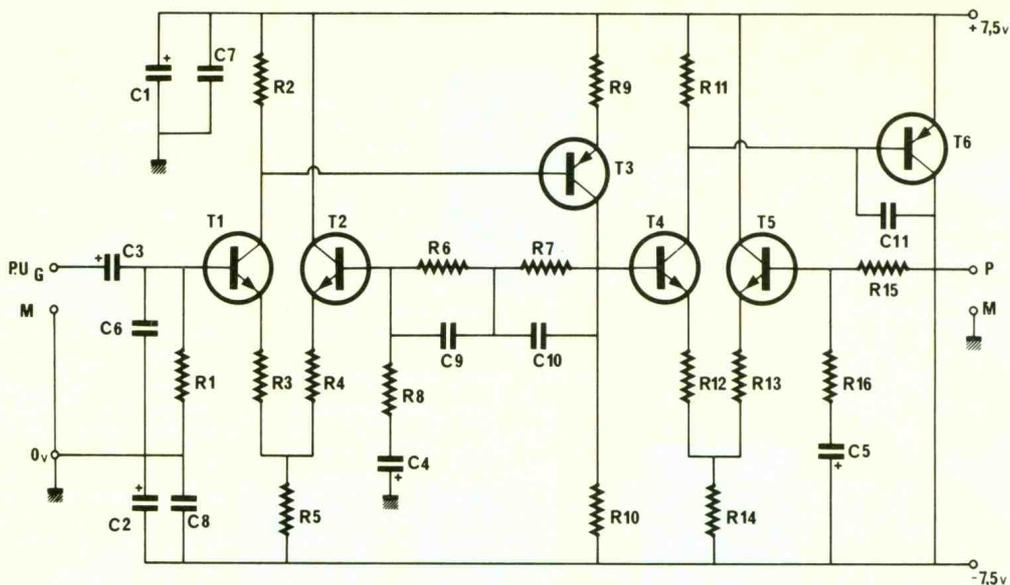
**Fig. 3** Schéma de principe du préamplificateur RIAA.
