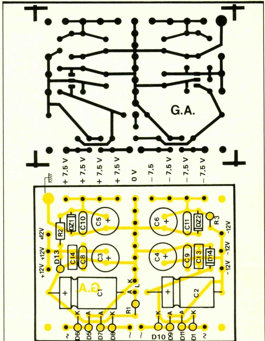
Fig. 11 Tracé du circuit imprimé de l'alimentation.
