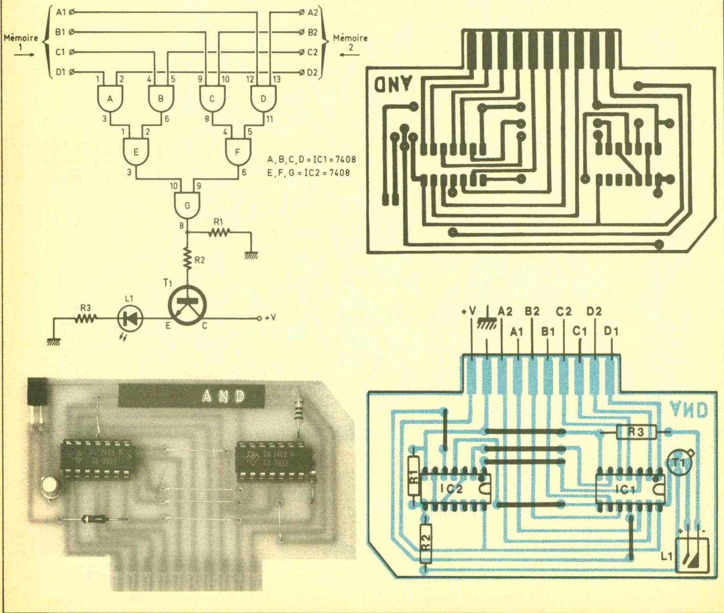
porte G commande, grâce au transistor T<sub>1</sub>, une simple LED dont l'allumage signifie bien sûr que la fonction AND est vraie ou vérifiée.
