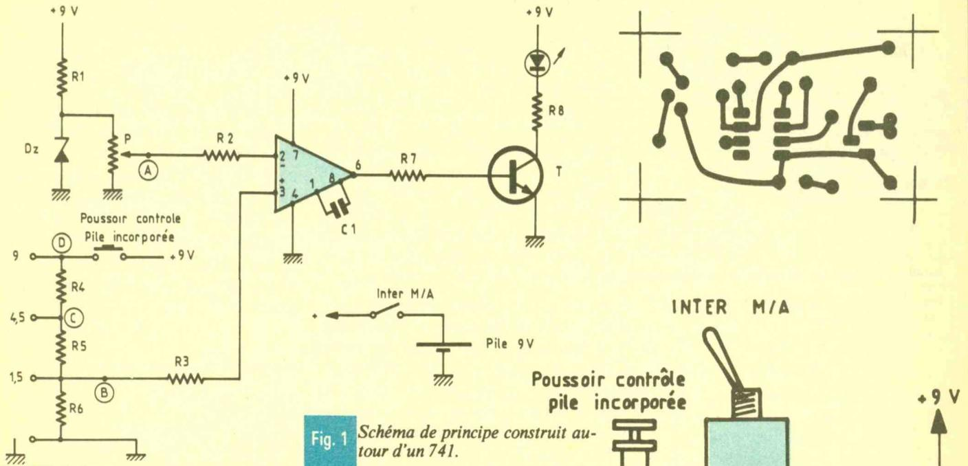
Fig. 1 Schéma de principe construit autour d'un 741.
