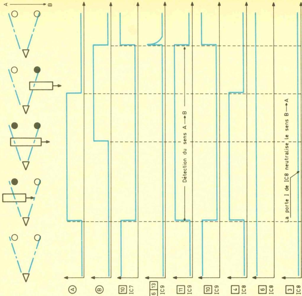
Oscillogrammes caractéristiques relevés en divers points du montage. Fig. 6
