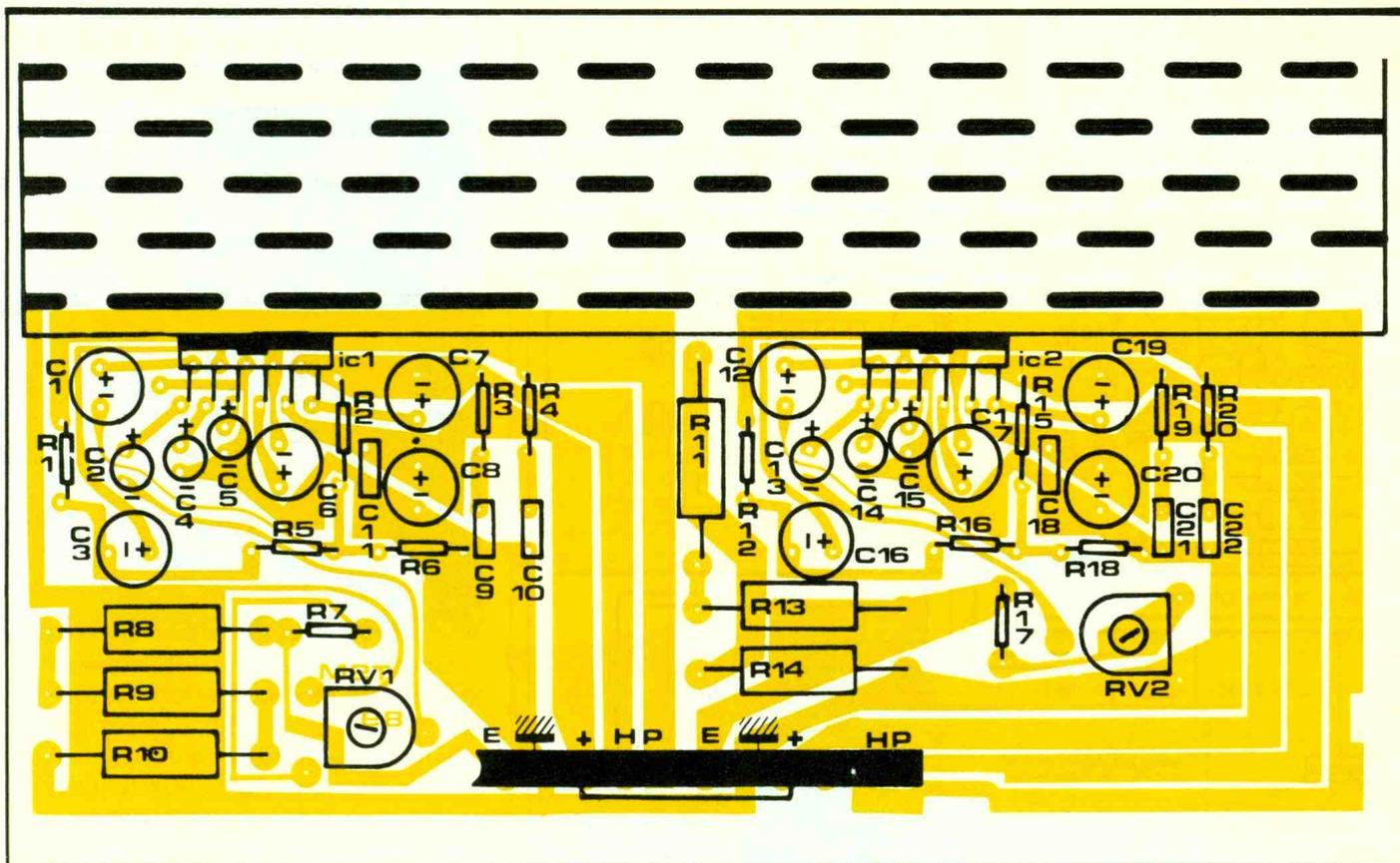
Fig. 3 Implantation des éléments avec l'imposant dissipateur.
