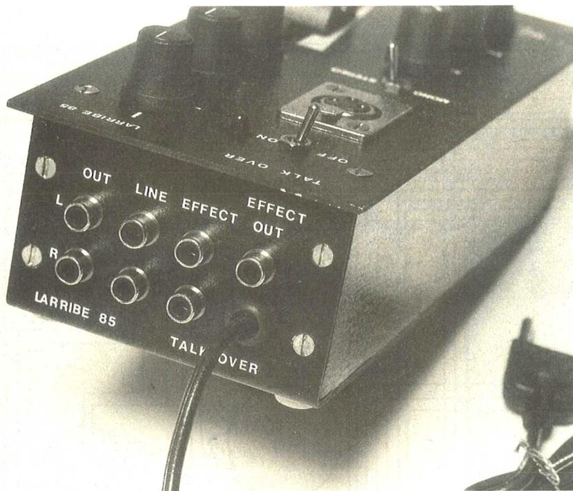
Photo 4. – Raccordements par fiches CINCH.
