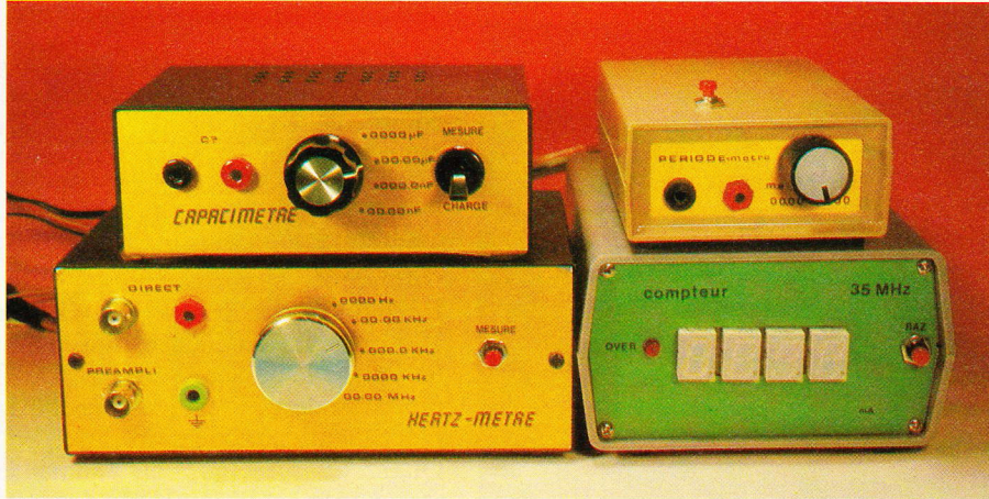
Photo 4. - L'ensemble terminé des quatre appareils de mesures numériques.
