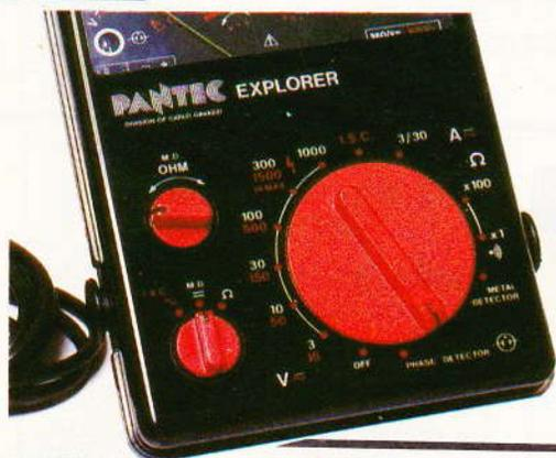
En effet, sur cette position du sélecteur, les cordons étant connectés aux prises plus et moins, en tenant dans la main l'un de ces derniers, on recherche la phase avec l'autre, et une ampoule néon, située en début d'échelle de cadran, s'illumine.
