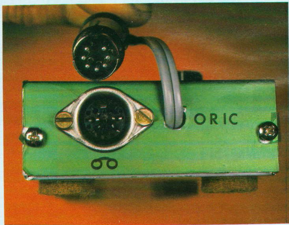
Photo 4. - Détails des entrées/sorties en DIN 7 broches.
