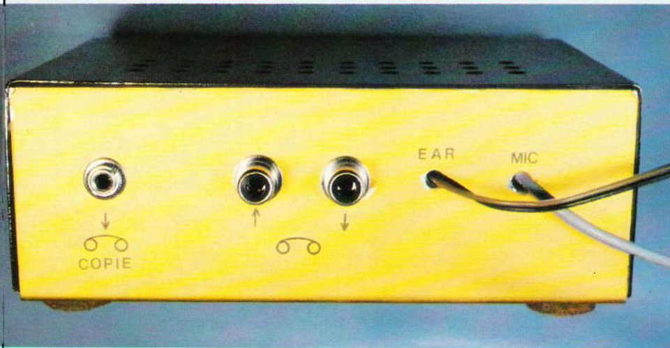
Photo 3. – La face arrière et les diverses prises.
