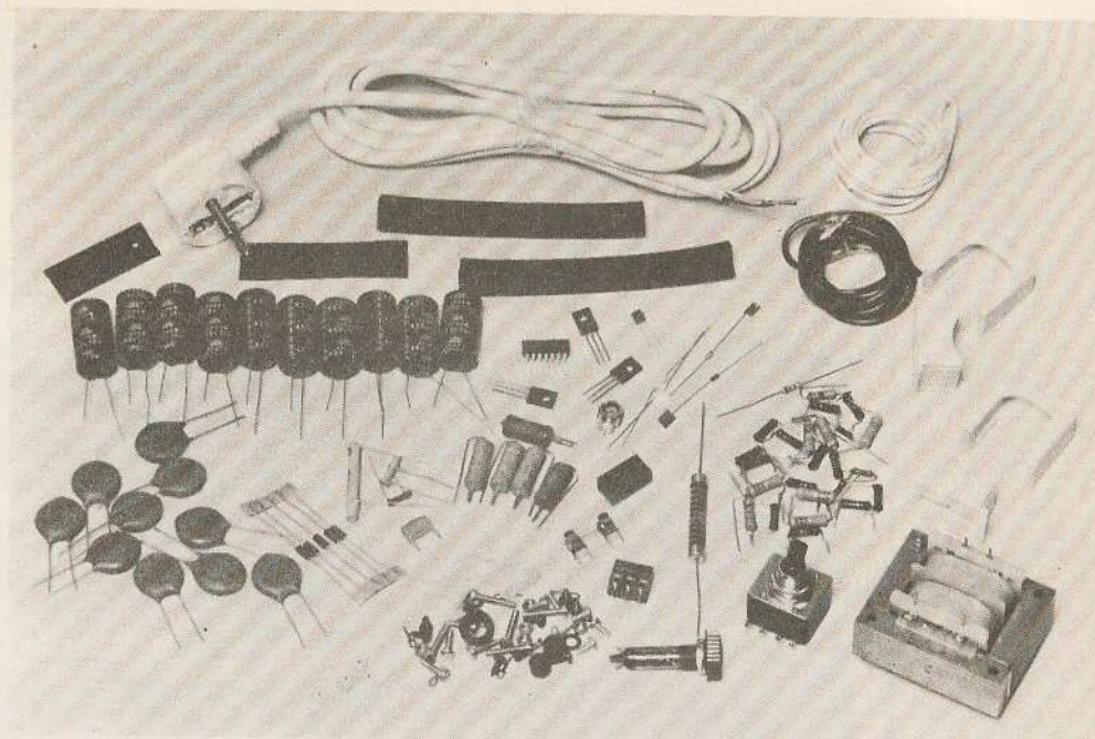
Photo 1A. — Oppermann, un kit laser équipé d'une alimentation très sophistiquée si l'on en juge par le nombre de composants utilisés.
