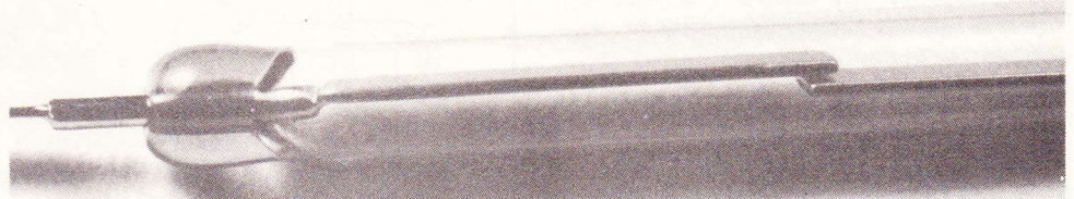
Photo 3. – Une ampoule ILS 1 T. Un champ magnétique extérieur fera coller les deux lamelles souples.
