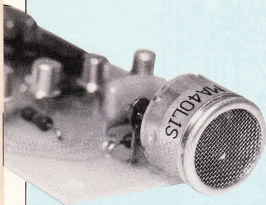
Photo 3. – Gros plan sur les types de transducteurs 40 kHz employés dans la réalisation.
