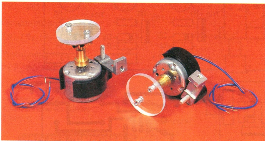
Aspect des moteurs utilisés et des miroirs.
