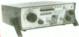
368. Générateur de fonction de 1 Hz à 200 kHz, sinus, carré, triangle, précision ± 5 %. T.T.L. Entrée wobulation extérieure
