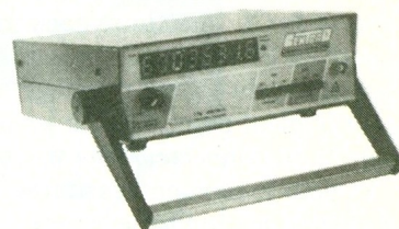
346. Fréquencemètre de 1 Hz à 600 MHz. 8 Digits diodes 13 mm. Base de temps : oscillateur à quartz 10 MHz
