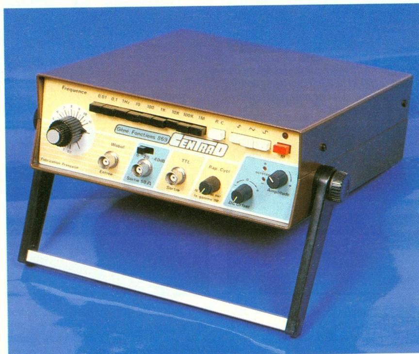
d'ondes (sinus, triangles et rectangles), et la mise en service de la commande de rapport cyclique. Un double potentiomètre – commande directe et rotation démultipliée – règle en continu la fréquence, au sein de chaque gamme. Linéaire de 1 à 11, l'échelle se resserre en début de gamme, de 0,1 à 1 : ce sont maintenant les normes, dictées par les circuits générateurs du courant de charge des condensateurs.
