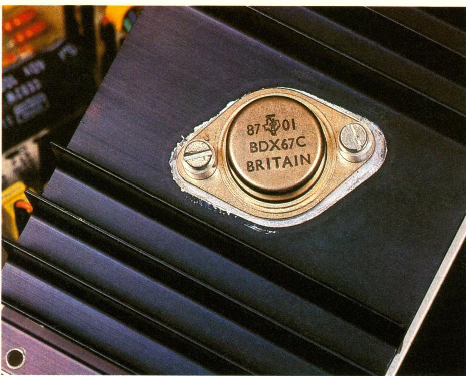
Photo 5. – Mise en place du transistor sur son dissipateur.
