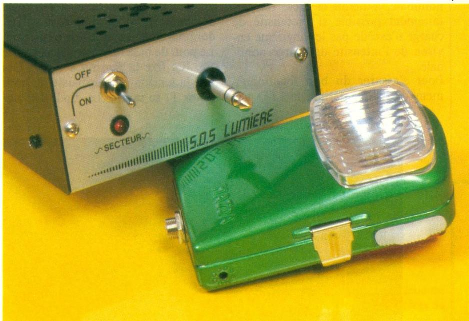
Le boîtier lampe électrique est relié au boîtier « électronique » par l'intermédiaire d'un jack stéréo à coupure, c'est bien pratique au niveau de la mobilité de la lampe électrique.
