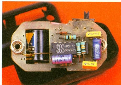
Le podomètre avec sa pile.
