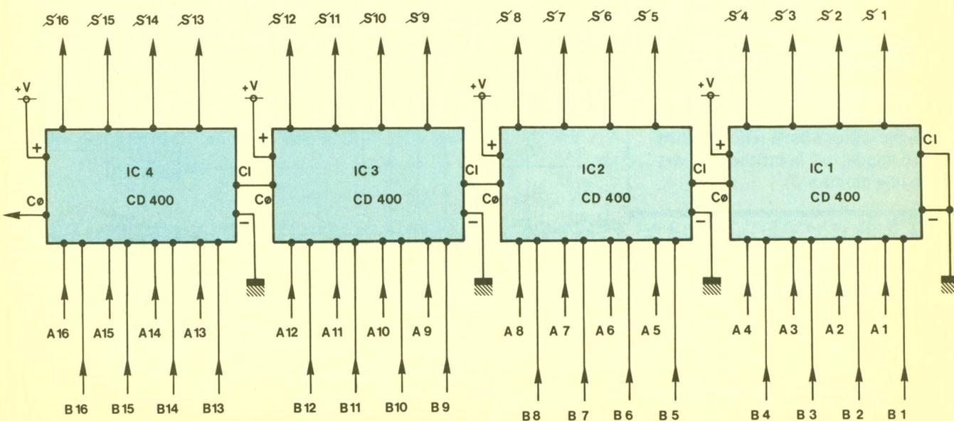
La figure 4 indique également l'écriture binaire du nombre B (26 341). En appliquant la table de vérité, étage par étage, on obtient le nombre binaire  $S_1, S_2 \dots S_{16}$ , qui représente l'addition de A et de B ; cette opération a été résumée dans le tableau contigu au schéma de la figure 4.
