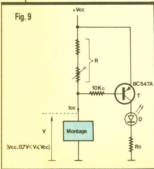
dépasse cette limite, T conduit et illumine la DEL D.  $R_D$  sera définie selon  $V_{cc}$ , environ  $V_{cc}/10$  mA. En utilisant pour R une résistance talon et un potentiomètre gradué, on réalise un mini-ampèremètre. Au moment de l'allumage de la DEL, on a  $I_{cc}$  égal à la graduation du potentiomètre. Sinon, avec une résistance fixe, ce dispositif sera utile, en sortie d'une alimentation, pour indiquer un dépassement...
