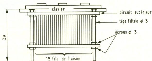
vra être raccordée à une borne B... voisine (voir photos). Bien vérifier l'absence de liaison intempestive au niveau des soudures du clavier. D'autre part, les chiffres non utilisés dans le code devront aboutir à l'une des cosses M comme représenté sur le schéma de principe.
