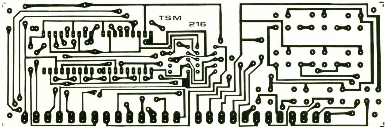
Fig. 2 A titre indicatif, tracé du circuit imprimé principal.
