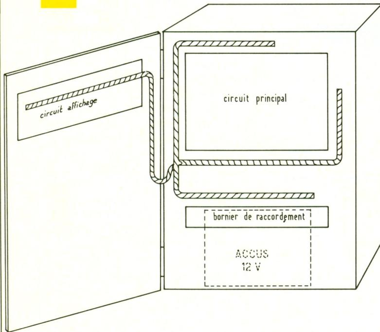
**Fig. 16** Exemple de raccordement avec une seule télécommande.
