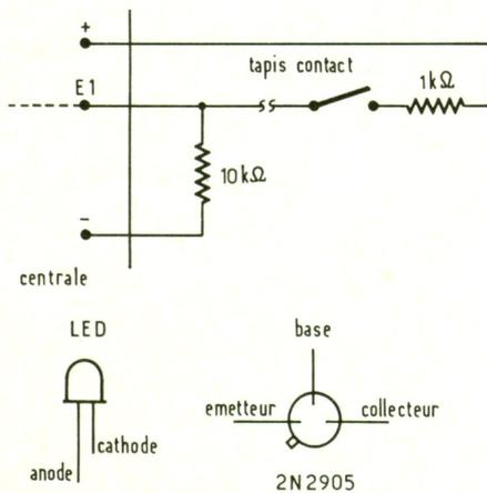
**Fig. 17** Exemple de raccordement de la centrale.
