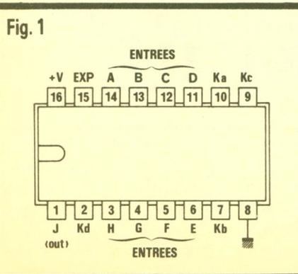
A, B, C, D, E, F, G et H, recevant les niveaux logiques à traiter sous forme de fonction. Une entrée « EXPAND » a son utilité en cas d'extension du nombre d'entrées. Trois entrées  $K_a$ ,  $K_b$  et  $K_c$  constituent la commande, sous la forme d'une information binaire, de la fonction souhaitée. Enfin, une entrée  $K_d$  permet la réalisation du découplage de la sortie unique J avec le circuit intégré.
