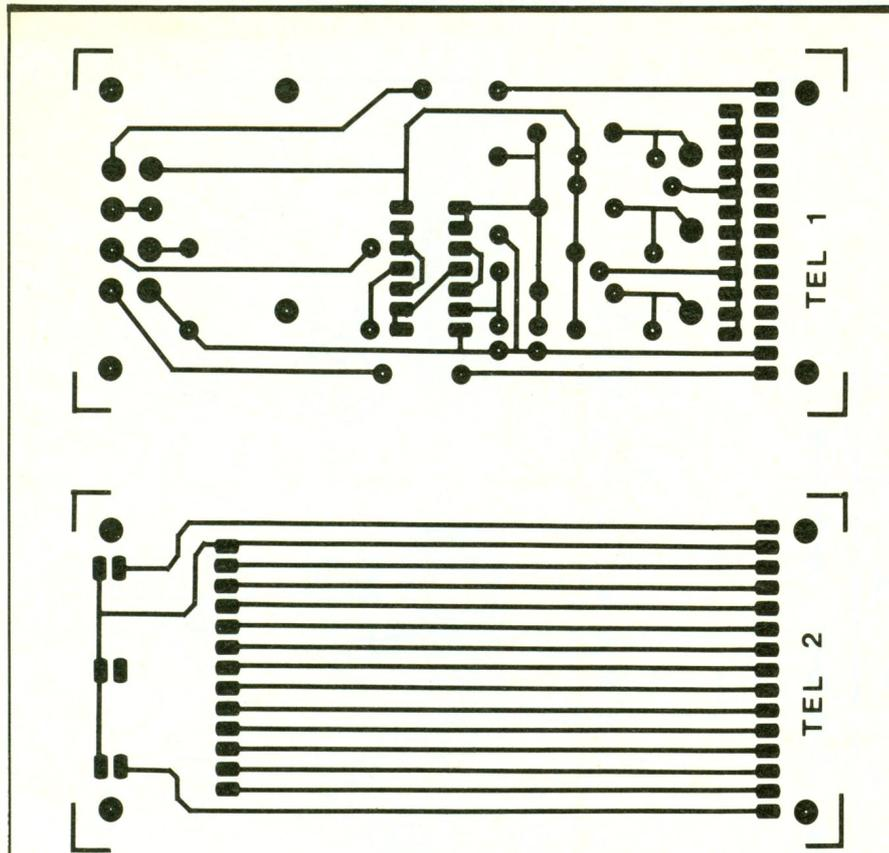
Détails de réalisation à l'échelle des circuits inférieur et supérieur. **Fig. 4 et 5**
