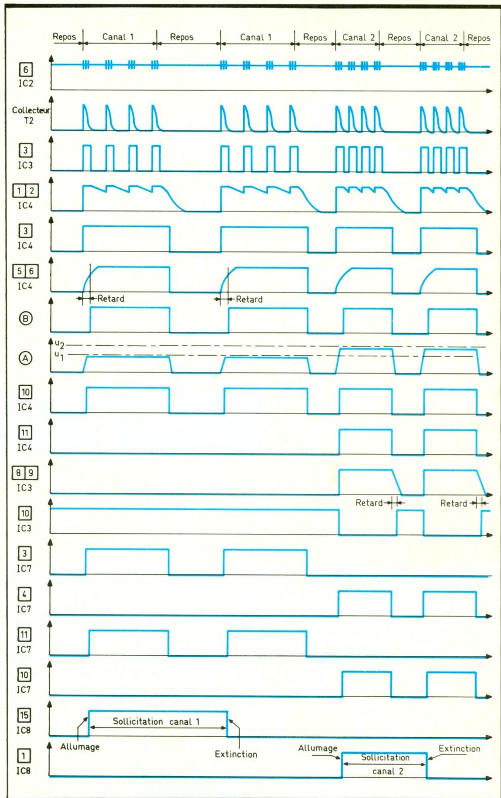
Fig. 6 Oscillogrammes récepteur.
