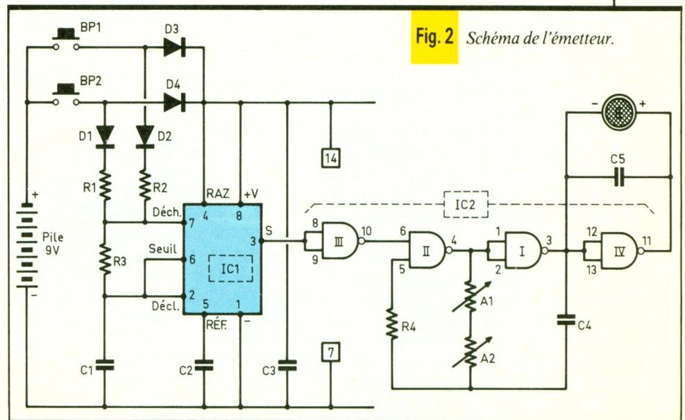
Fig. 2 Schéma de l'émetteur.
