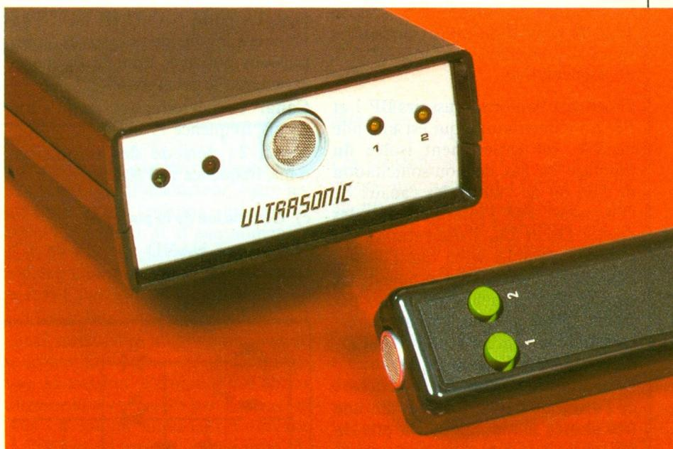
sions, à une fréquence beaucoup plus faible. L'une de ces basses fréquences correspond au canal numéro 1, tandis que l'autre est affectée au canal numéro 2. Ces basses fréquences retenues pour la différenciation des deux canaux sont respectivement de l'ordre de 75 Hz et de 160 Hz.
