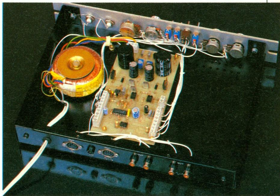
Le quatrième étage, qui n'est autre que le générateur de signaux proprement dit commutable en trois gammes de fréquences, est commandé par le troisième, soit en tension continue,
