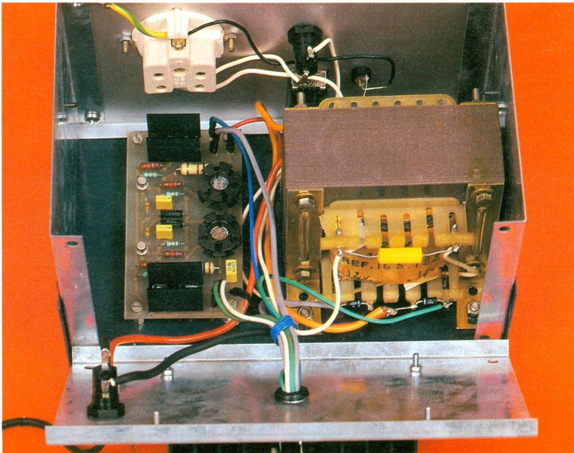
L'ensemble T<sub>1</sub>, T<sub>3</sub>, T<sub>5</sub> apporte donc un gain en courant de l'ordre de 20 000. La consommation sur l'oscillateur – courant de base de T<sub>5</sub> – sera dans tous les cas inférieure à 0,5 mA.
