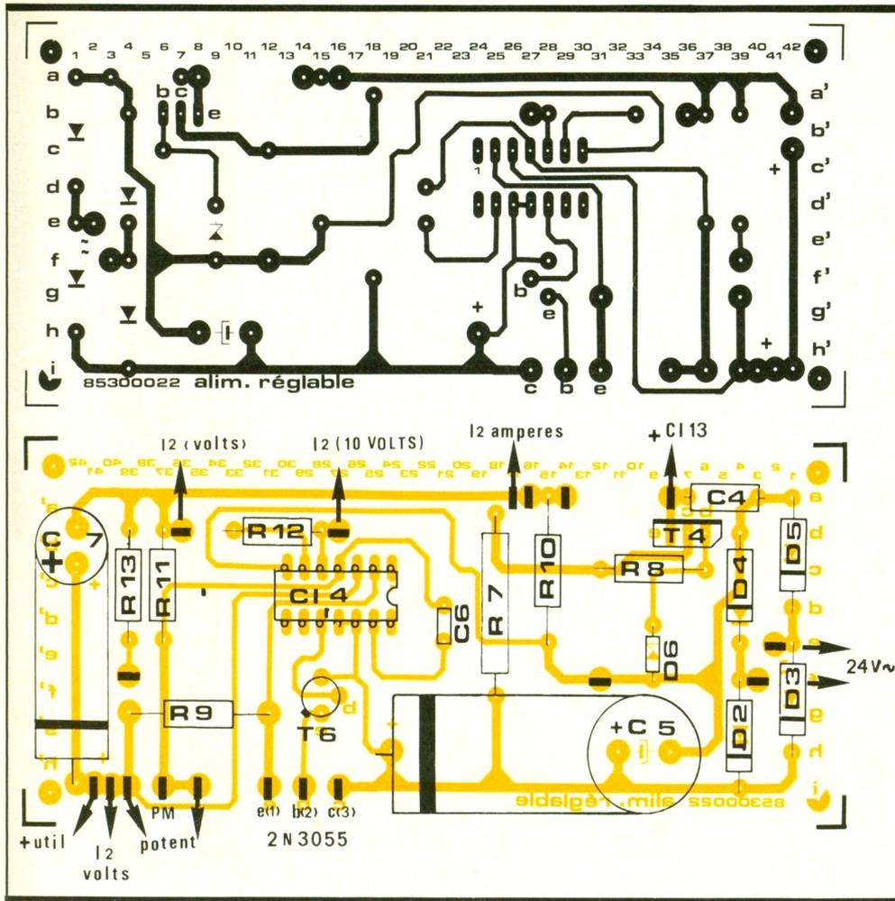
**Fig. 3 et 4** Détails de l'autre carte imprimée.
