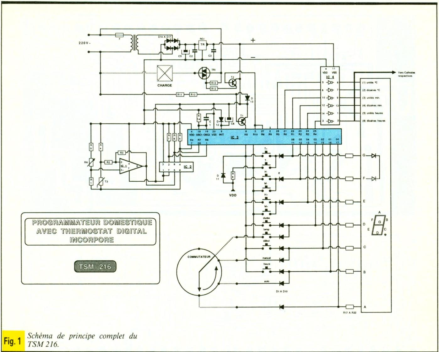
Fig. 1 Schéma de principe complet du TSM 216.
