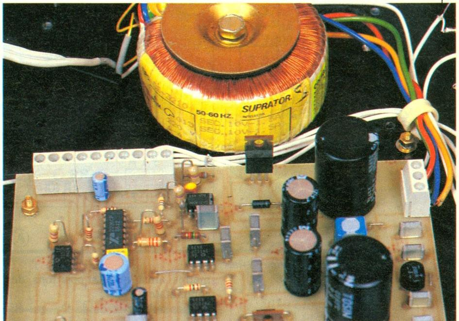
Photo 4. - Utilisation d'un transformateur torique.
