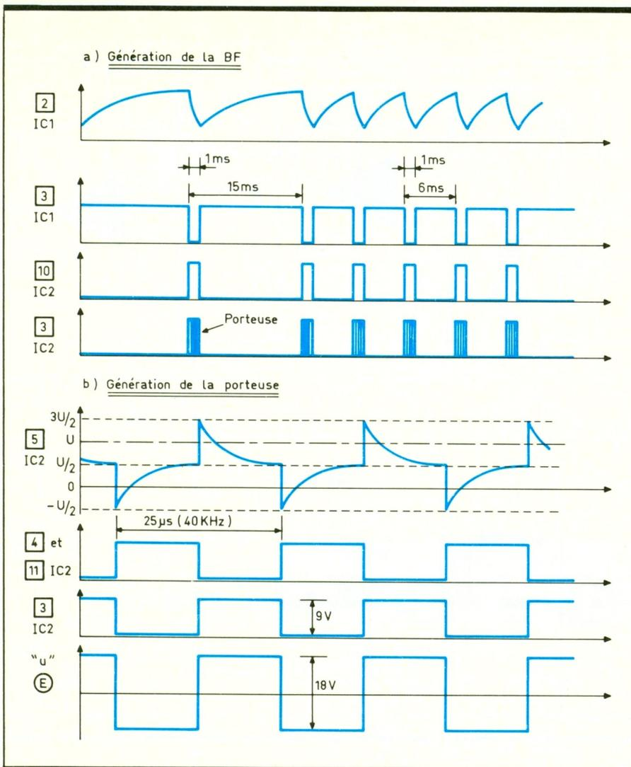
**Fig. 3** Oscillogrammes émetteur.
