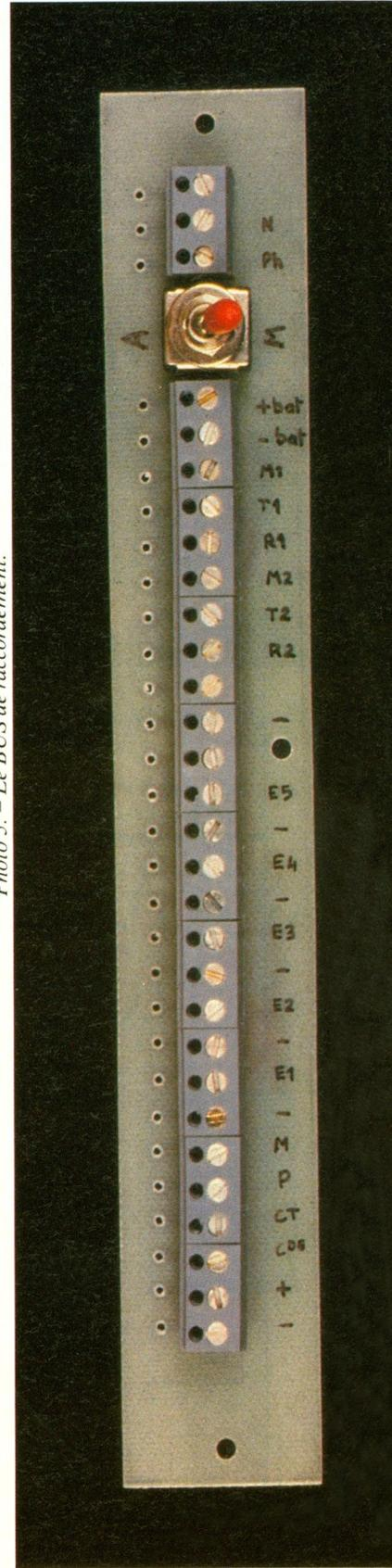
ne pose aucun problème particulier. Le bornier devra cependant être bien aligné pour une présentation correcte. S'assurer de l'absence de liaison (soudure) entre les six bornes de l'interrupteur M/A.
