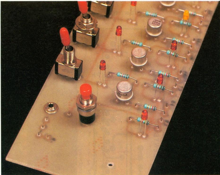
Photo 4. - Détails de montage des interrupteurs.
