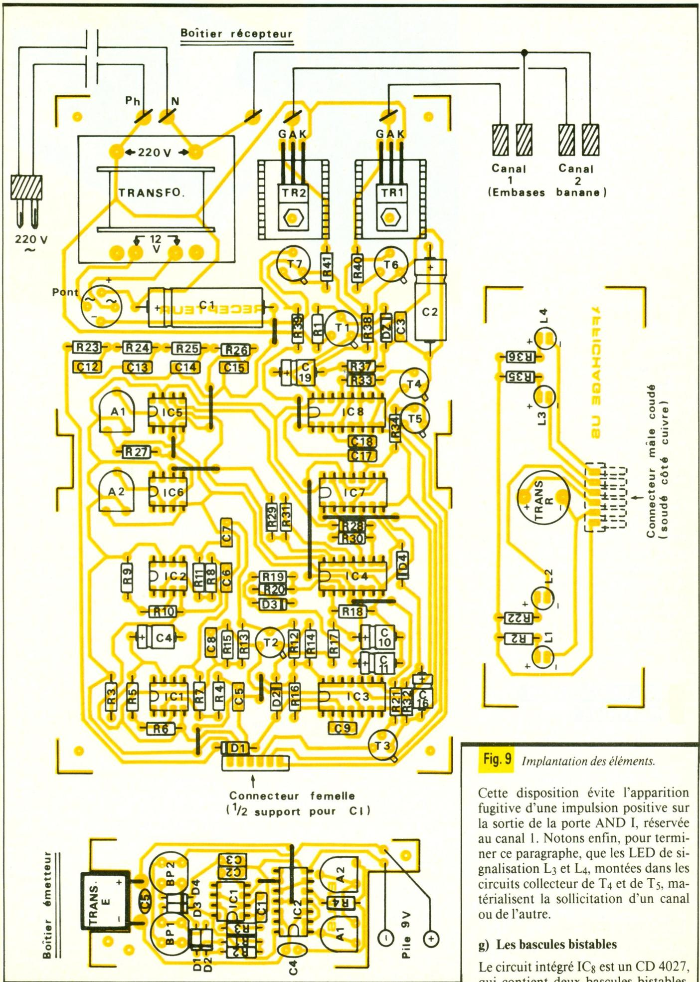
**Fig. 9** Implantation des éléments.
