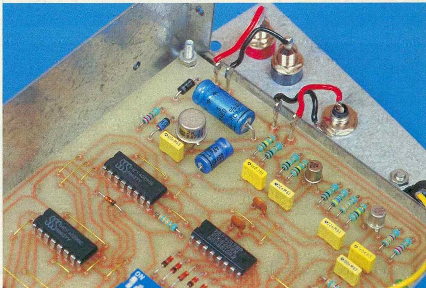
diode  $D_2$  et les résistances  $R_{17}$  et  $R_{18}$  constituent un circuit dérivateur. En effet, grâce à  $C_{11}$ , il y a transmission d'une impulsion positive de charge de celle-ci, pendant un court instant, pour chaque front ascendant du signal issu du multivibrateur.
