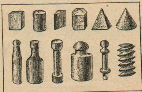
Fig. 1 à 12. — Exercices de menuiserie simple. Solides taillés au couteau.
