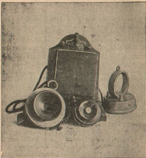
Fig. 176. — Poste microphonique complet (construction de l'auteur).
