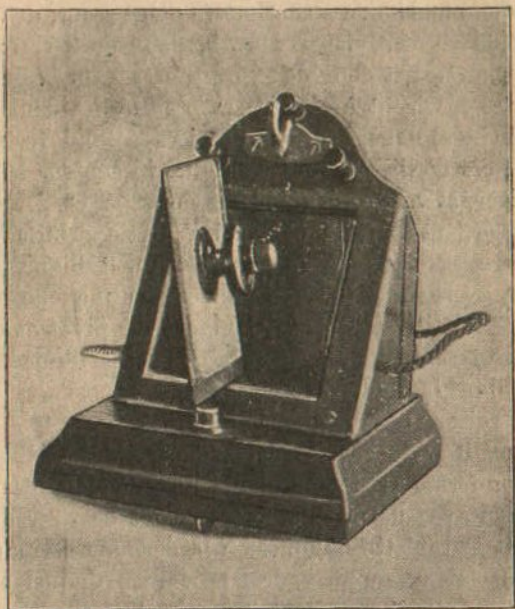
Fig. 174. — Transmetteur microphonique ouvert pour montrer l'agencement intérieur.
