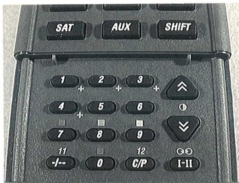
répandue sur de nombreux appareils pour l'entrée de numéro de chaîne supérieur à neuf, une touche C/P de sélection canal ou programme et une touche I/II correspondant à la sélection du canal audio gauche ou droit, soit quinze touches au total.
