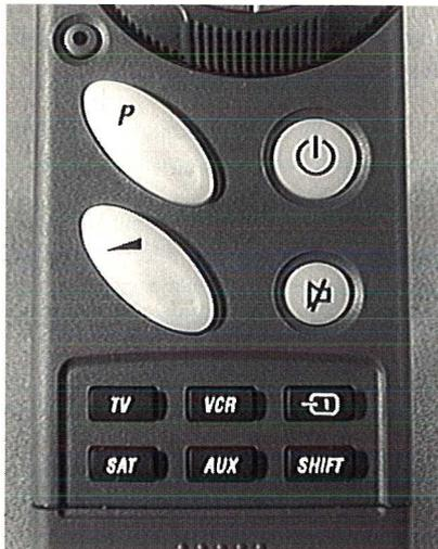
On y trouve le volume et le changement de programme par touches "plus et moins", la commande de mise en veille et de coupure son ainsi qu'une touche rouge de fonction "enregistrement" du (ou des) magnétoscopes (ou magnétophones).
