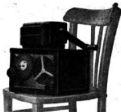
Le récepteur et la machine d'alimentation à main. Les barreaux qui protègent normalement l'avant du poste ont été élevés pour la photographie ; la chaise donne l'échelle.
