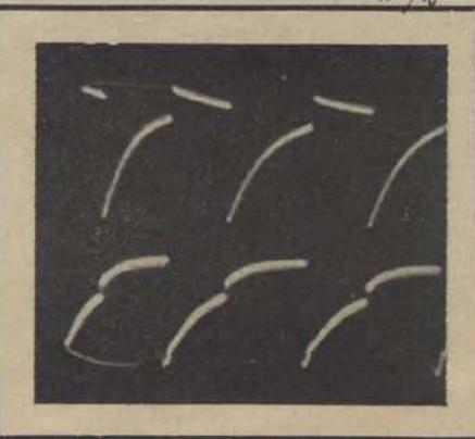
Fig. 2. — L'onde produite par le multivibrateur. En haut, la tension-grille, en bas, la tension-plaque d'une même triode.
