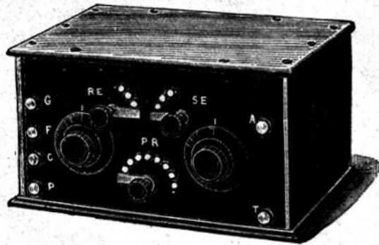
Récepteur pour Téléphonie pour ondes 140 à 600 type Reinartz
