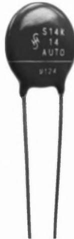
Figure 6.6 Varistance en forme de disque.
