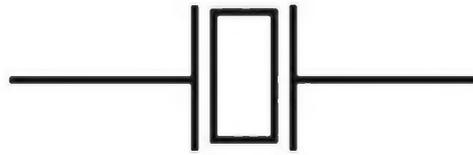
Figure 5.1 Symbole normalisé du résonateur à quartz ou du résonateur en céramique.
