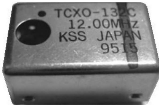
Figure 5.12 Oscillateur à quartz.
