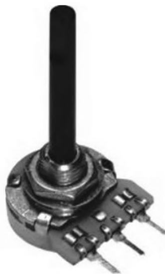
Figure 1.18 Potentiomètre rotatif.
