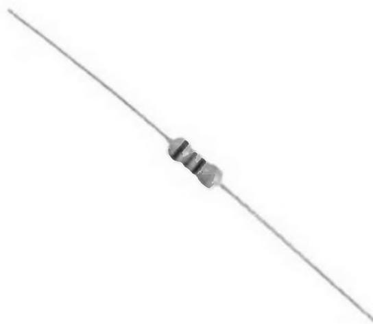
Figure 1.13 Résistance à couche de carbone.
