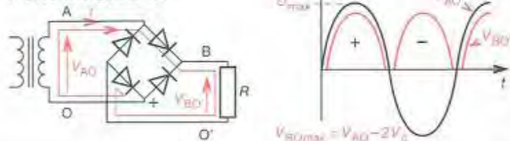
PONT DE GRAETZ
