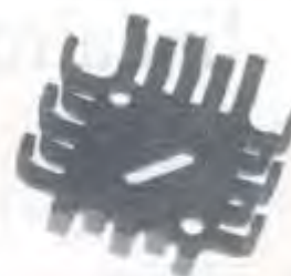
Boîtiers TO 220 - TO 3 R_{th} 7\text{ °C/W}
