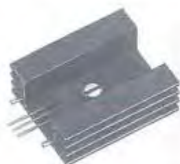
Boîtier TOP 3 R_{th} 5\text{ °C/W}
