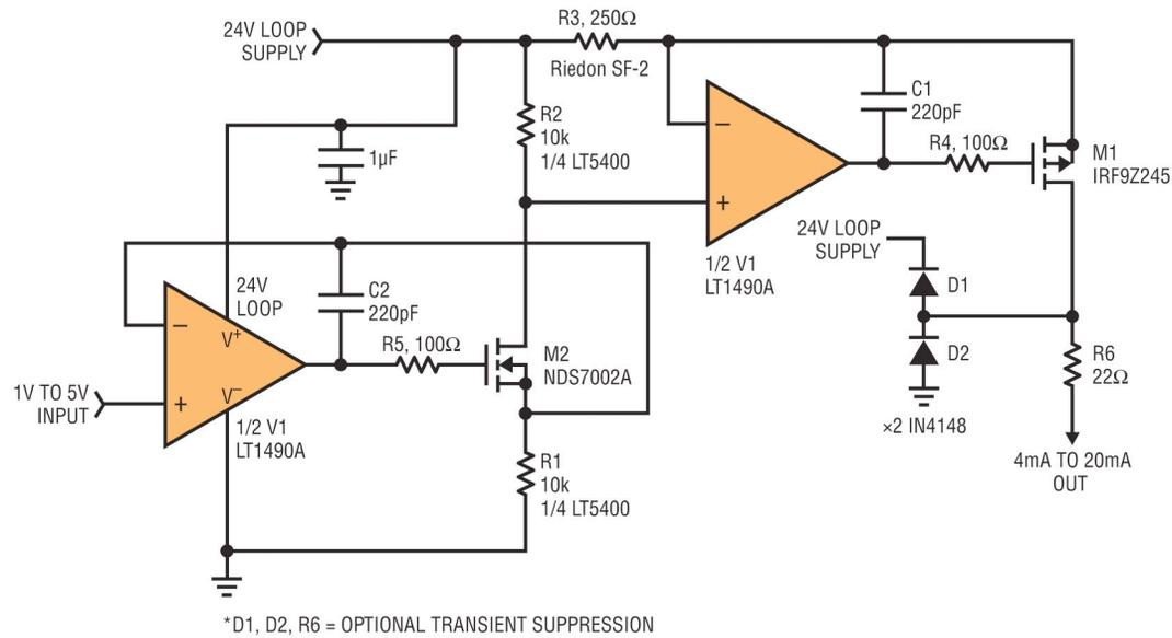
**Figure 1. Résistances de précision appariées permettant une conversion précise de la tension en courant.**
