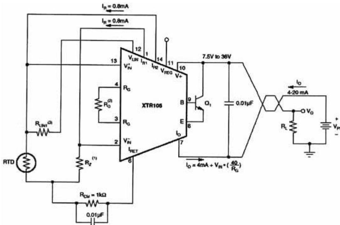
Le schéma ci-dessous présente une boucle 4-20 mA qui est composée d'un capteur de température, d'un émetteur le XTR105 de Texas Instruments, un récepteur le RCV420 de Texas Instruments (avant Burr-brown) qui réalise l'alimentation de la boucle et converti le 4-20 mA en une tension
