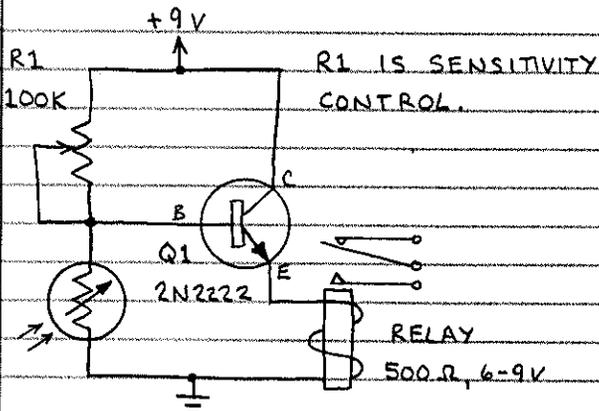
RELAY IS ACTUATED ONLY WHEN THE PHOTORESISTOR IS DARK.
