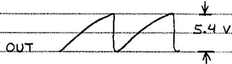
RAMPS SUPPLY GRADUALLY INCREASING VOLTAGE TO MANY KINDS OF CIRCUITS.
