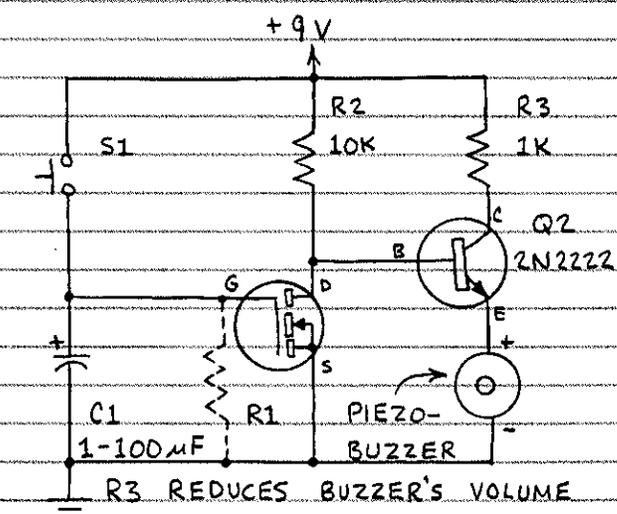
Q2 INVERTS THE STATUS OF Q1. THEREFORE THE BUZZER SOUNDS AFTER THE TIME DELAY IS COMPLETE. INCREASE C1'S VALUE TO INCREASE DELAY.
