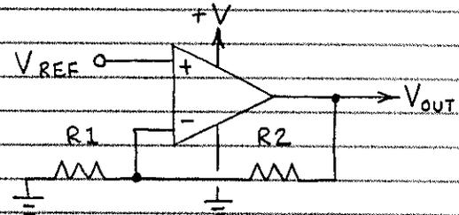
ACTUAL IC REGULATORS INCLUDE EXTRA BASIC VOLTAGE REGULATOR TRANSISTORS TO PROVIDE  $V_{REF}$
