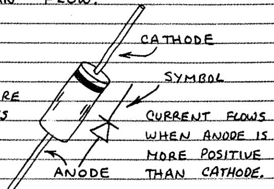
□ DIODE OPERATION — YOU ALREADY KNOW A DIODE IS LIKE AN ELECTRONIC ONE-WAY VALVE. IT'S IMPORTANT TO UNDERSTAND SOME ADDITIONAL ASPECTS OF DIODE OPERATION. HERE ARE SOME KEY ONES:
