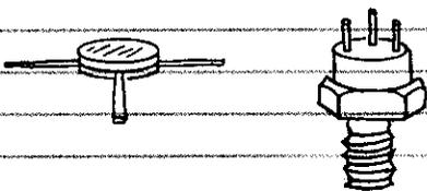
HIGH-FREQUENCY TRANSISTORS OPERATE AT RADIO, TELEVISION AND MICROWAVE FREQUENCIES. THE BASE REGION IS VERY THIN AND THE ACTUAL CHIP IS VERY SMALL.
