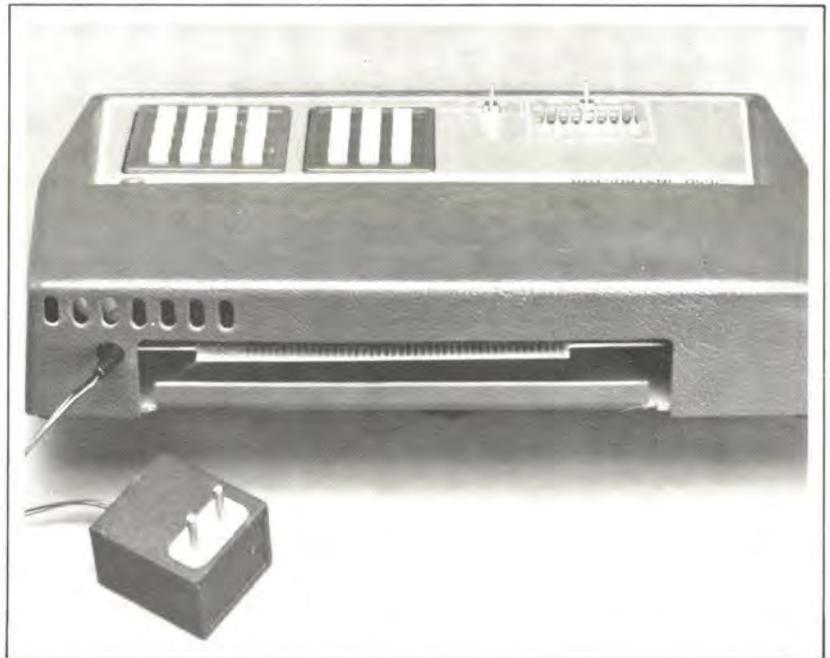
L'I 50 vue par sa face arrière. On aperçoit le circuit imprimé avec son BUS 100. Au premier plan, le transformateur d'alimentation.
