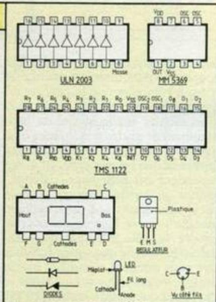
Fig. 13. Brochage des semi-conducteurs.
