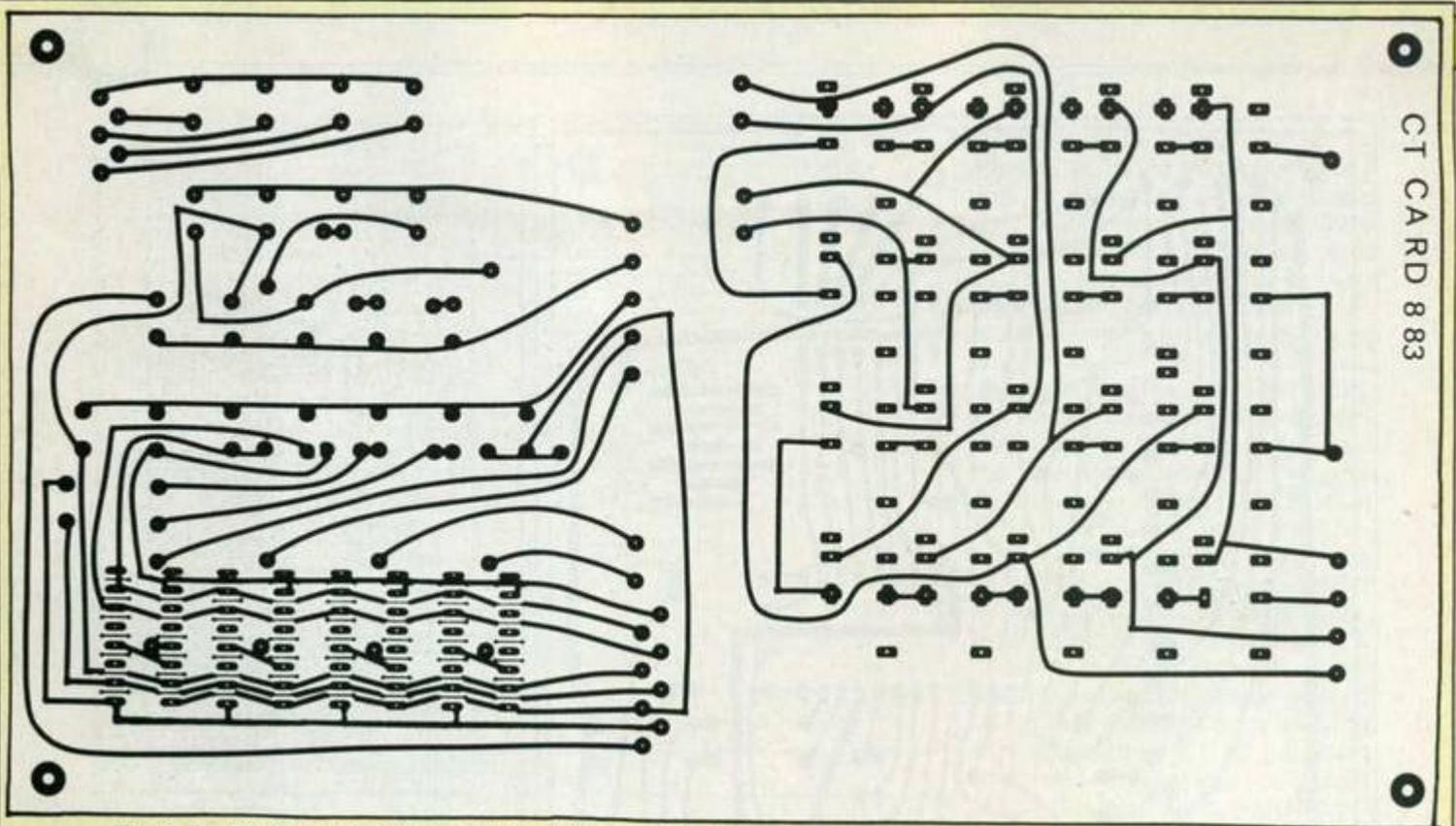
Fig. 6. Le circuit imprimé regroupant les afficheurs et le clavier.
