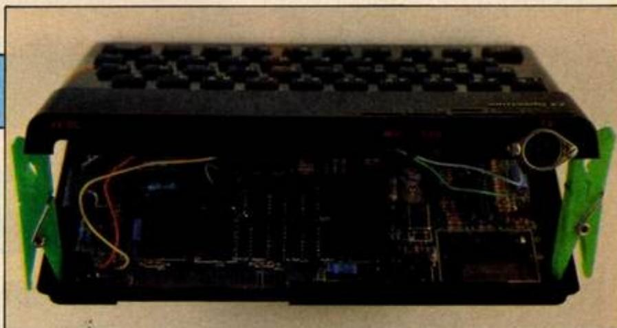
Une partie du circuit imprimé est utilisée en connecteur encartable.
