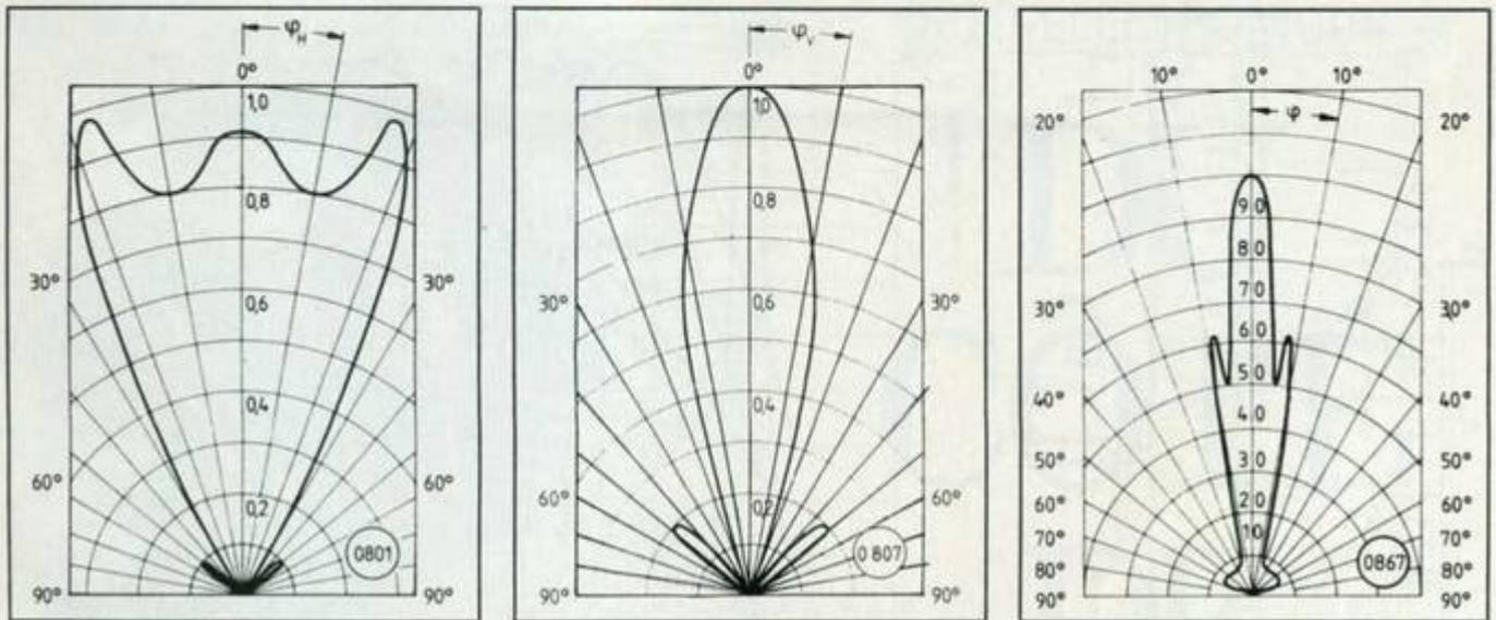
Fig. 4. Exemples de diagrammes de rayonnement dans les plans horizontal et vertical pour la LD273, dans le plan vertical pour la LD274.
