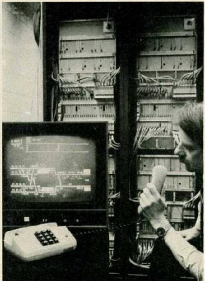
signaux au poste d'aiguillage. Pour atteindre la fiabilité absolue, tous les micros du système «Simis» sont doublés. Il est en outre possible de raccorder un poste d'aiguillage électronique à un autre ou à un système hiérarchiquement
