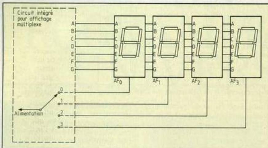
Fig. 3. Schéma de principe d'un affichage multiplexé.
