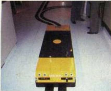
Véhicule à guidage optique (Matra).
