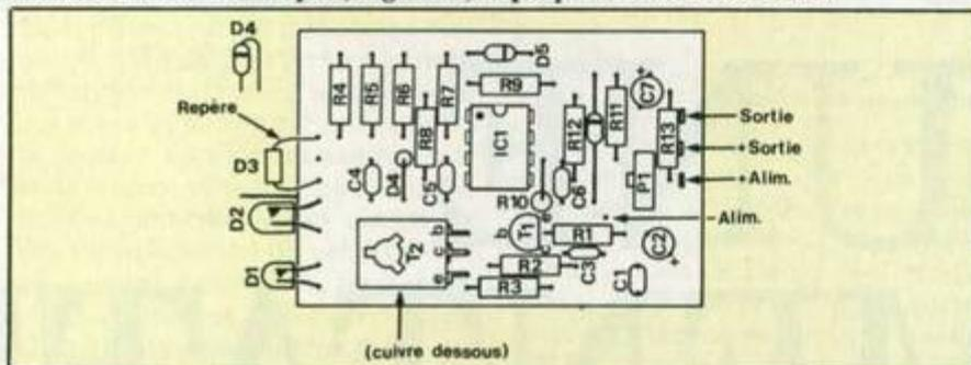
Implantation des composants : on veillera à respecter les polarités des chimiques et des semi-conducteurs et à isoler, optiquement, D2 de D3.
