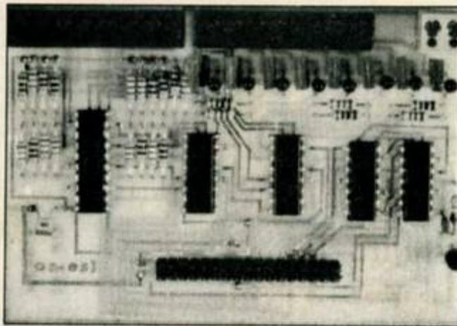
pour l'Oric-1, l'autre (8ES) pour le ZX-81. Ces cartes peuvent recevoir 8 entrées et permettent de piloter 8 sorties. On entend par entrée un signal binaire pouvant prendre les valeurs 0 à 1 : un détecteur de seuil, d'humidité, un interrupteur, un comparateur, un détecteur d'obstacle peuvent fournir un tel signal, à charge pour
