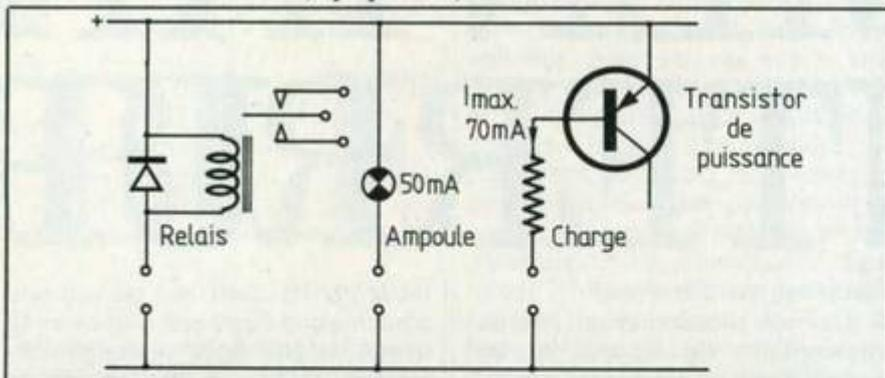
Différentes charges : au-delà de 70 mA on utilisera un transistor de puissance.
