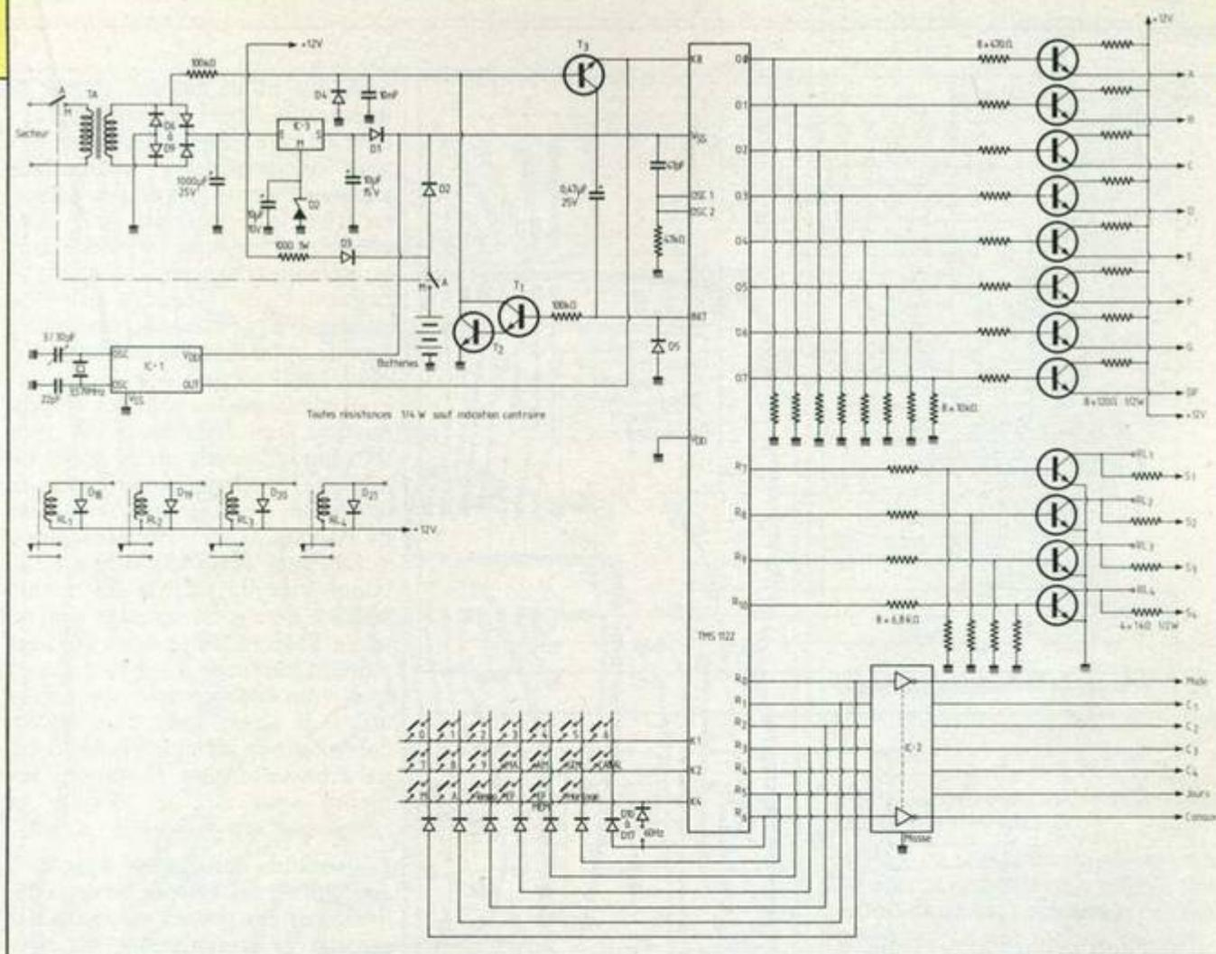
Fig. 1. Le schéma de principe du programmeur décrit : il est bâti autour du TMS 1122, micro-processeur spécialisé.
