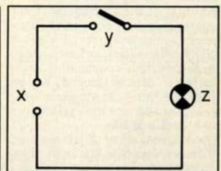
Figure 3. Un circuit ET élémentaire.
