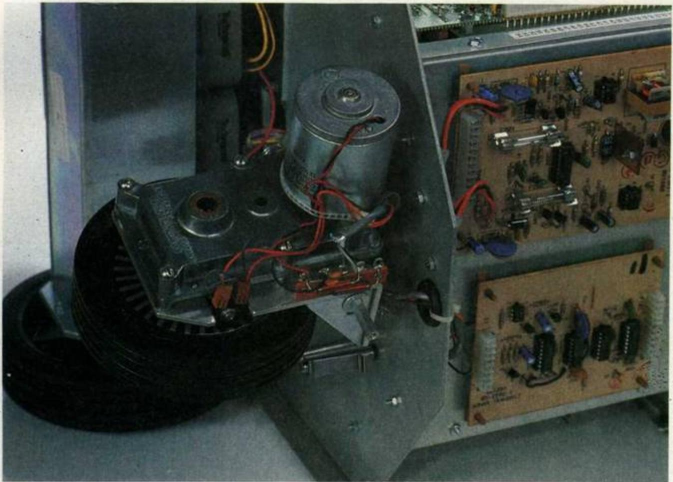
La roue motrice et directrice avec son disque de codage optique et le détecteur associé.
