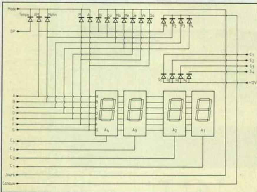
Fig. 2. Schéma de la fonction affichage.
