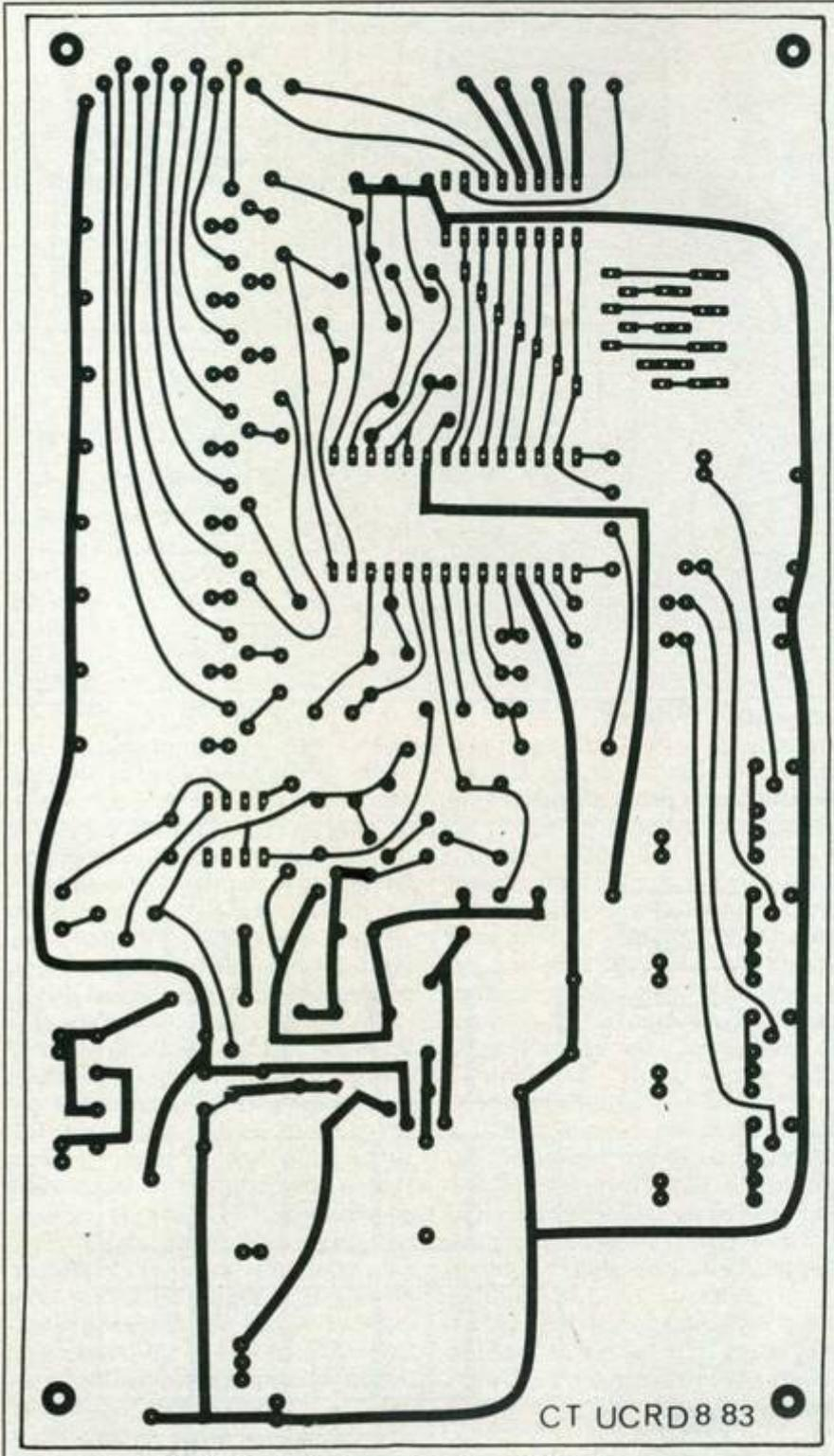
Fig. 5. Circuit imprimé principal, vu côté cuivre, échelle 1.
