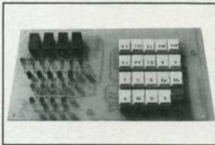
Le circuit d'affichage avec le clavier de type Digitast.
