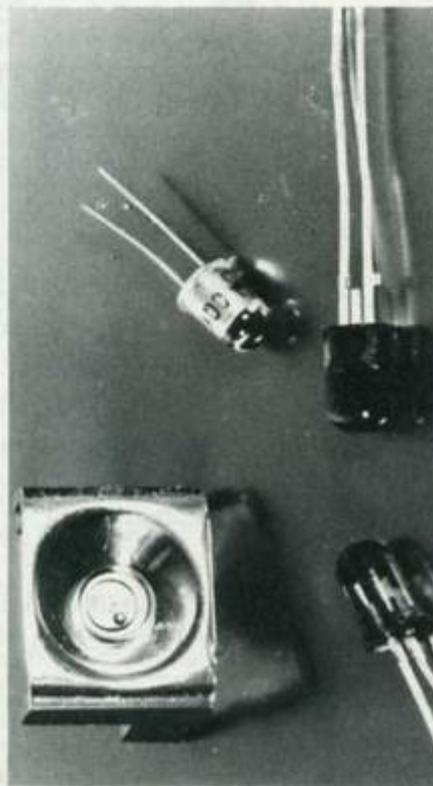
Diodes Led IR : l'une est positionnée au centre d'un réflecteur servant de radiateur.
