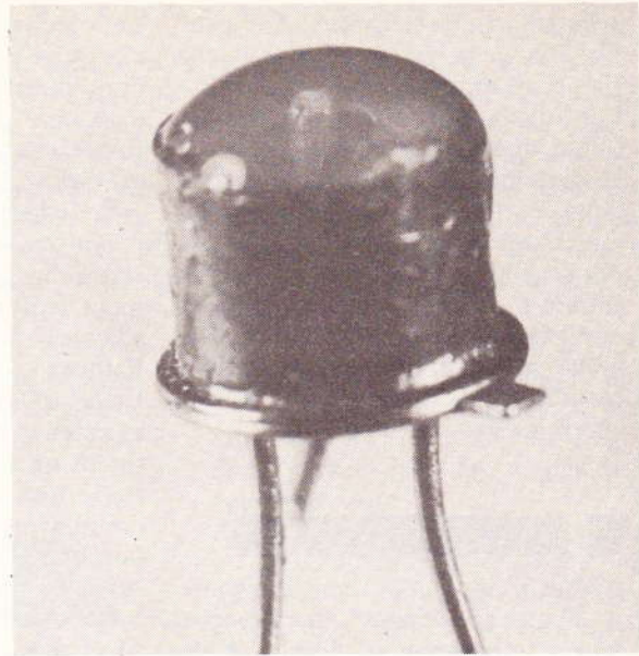
Photo 3. – Un photo-transistor « maison » : un BC 109 décalotté plus une goutte de silicone pour le protéger.
