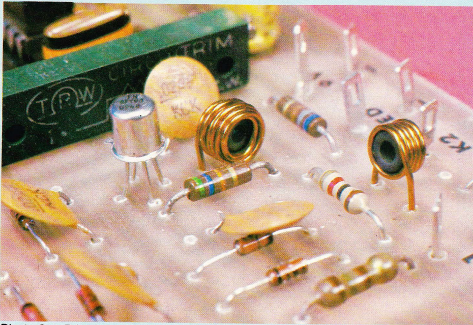
Photo 2. – Détails de réalisation des selfs.
