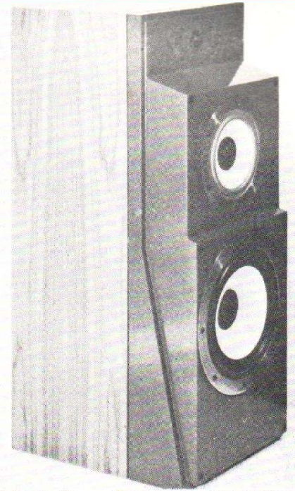
Photo C. - Enceinte acoustique LEAK 3080. Ici la mise en phase est assurée par décalage des haut-parleurs pour compenser le déphasage apporté par le filtre.
