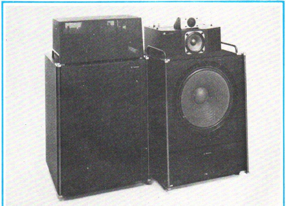
Photo D. - Enceinte Technics SB 7000 : l'ensemble filtre-haut-parleurs donne une mise en phase convenable à condition que les bobines mobiles soient dans un même plan, ce qui est fait ici.
