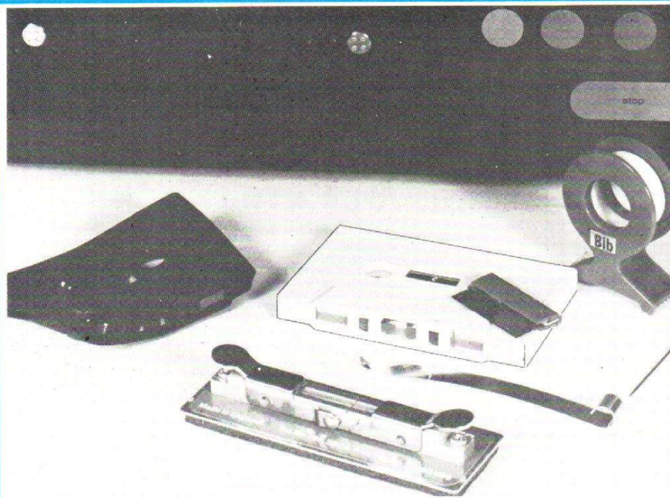
Ce qui peut arriver à une cassette exposée au soleil... A droite de quoi récupérer la bande.
