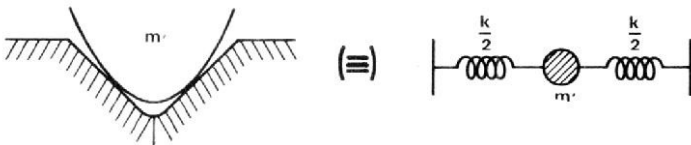
Fig. 3. - La masse ramenée m' de la pointe de lecture et de l'équipage mobile d'une cellule de tourne-disque constituée, avec les flancs du sillon de raideur k/2 , un système oscillant du premier ordre de fréquence de résonance
