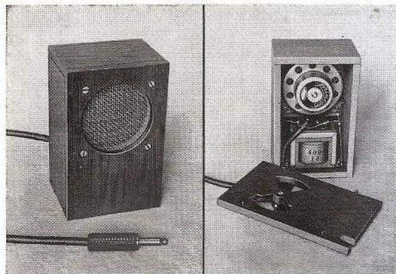
A gauche : un microphone dynamique. — A droite : l'intérieur du microphone dynamique.
