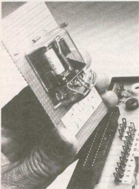
Photo 8. — Trois secondes pour enficher un montage passe-partout précâblé.
