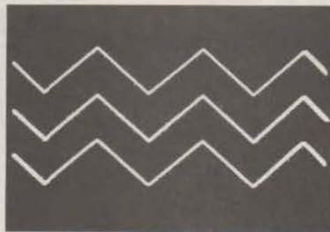
Oscillogramme G. – Relevé avec un oscilloscope bicourbe, cet oscillogramme montre que le gain du commutateur égale l'unité, sur chaque canal.
