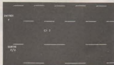
Photo 4. — Diviseur de fréquence par deux par CI2.
