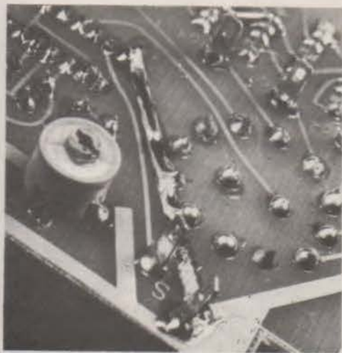
Photo 1. – Les deux rotacteurs sont solidaires du circuit imprimé.
