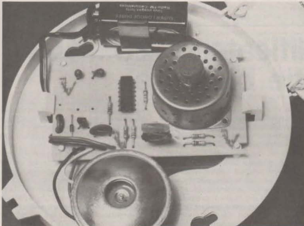
Photo 2. — La section électronique avec le capteur spécial et, au premier plan, le buzzer.
