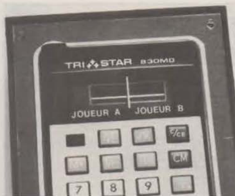
Photo 4. — Modification de l'afficheur de la calculatrice avec des lettres transfert.
