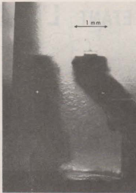
Photo 1. — Après moulage du plastique trouble on discerne la puce et son fil d'anode.
