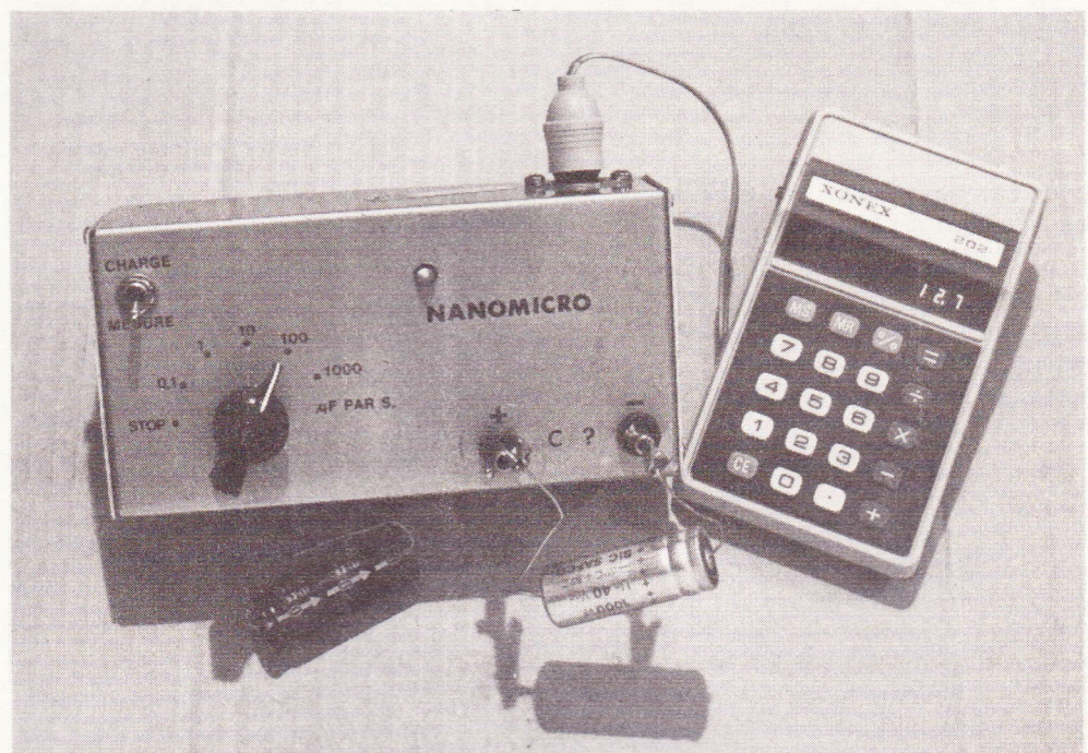
Photo 5. — Les mesures seront automatiques et plus précises en reliant l'appareil à une calculatrice modifiée.
