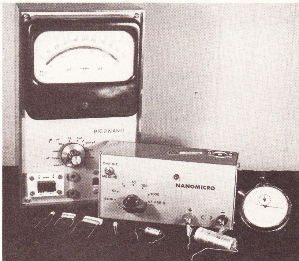
Photo 6. — Depuis 1 pF jusqu'à 20 000 \mu\text{F} avec ce tandem de capacimètres.
