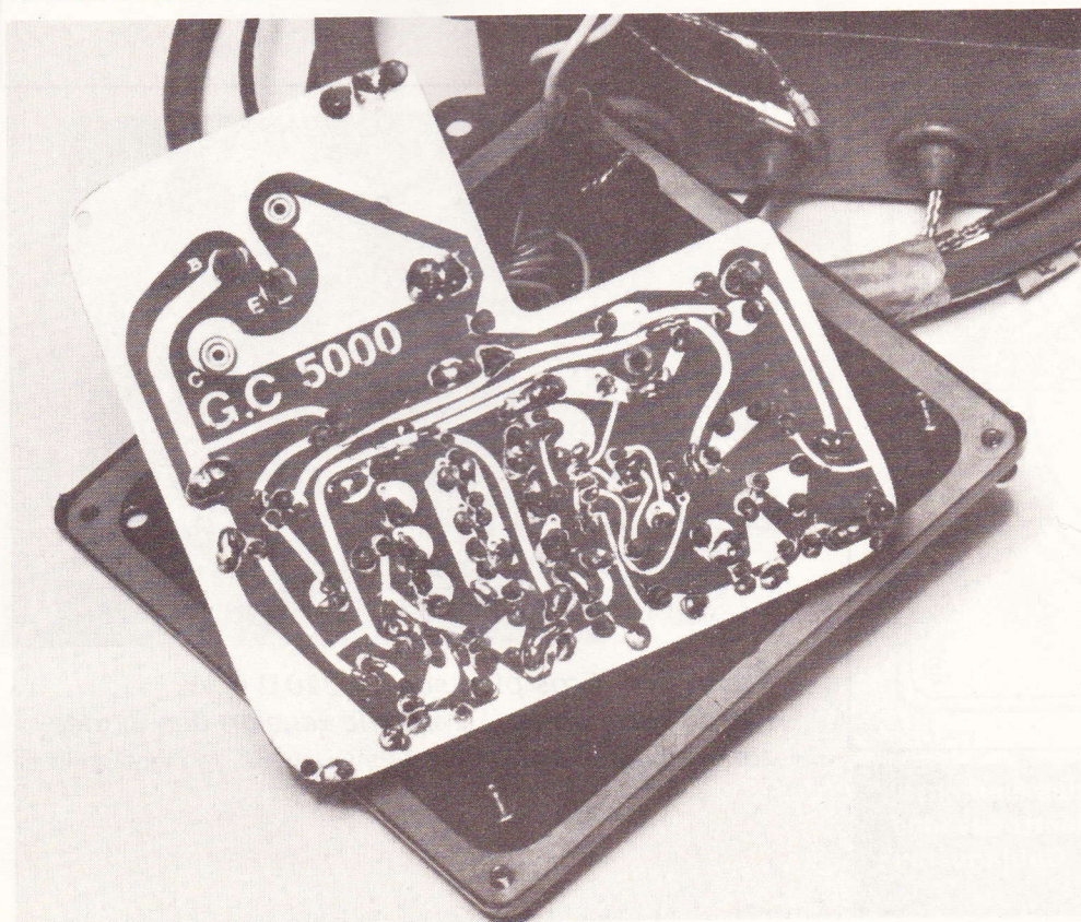
Fig. 3. — Le tracé du circuit imprimé publié grandeur nature se reproduira facilement à l'aide d'un stylo marqueur de qualité, ou bien des éléments de transfert direct, ou encore par le procédé « photo ».
