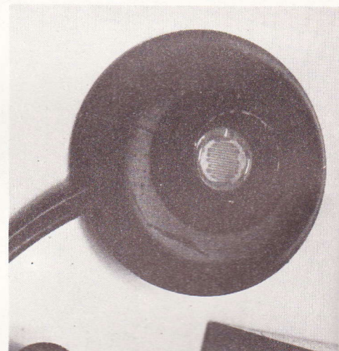
Photo 4. – Encapsulage de la cellule photo-résistive.
