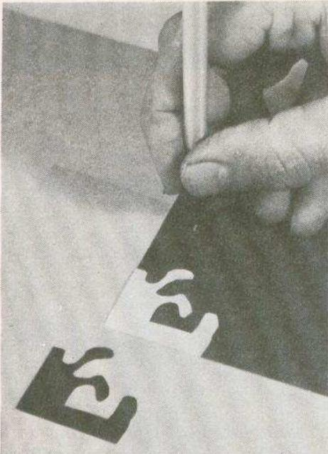
Photo 3. – La plage de masse est décalquée puis découpée dans l'adhésif Normapaque.
