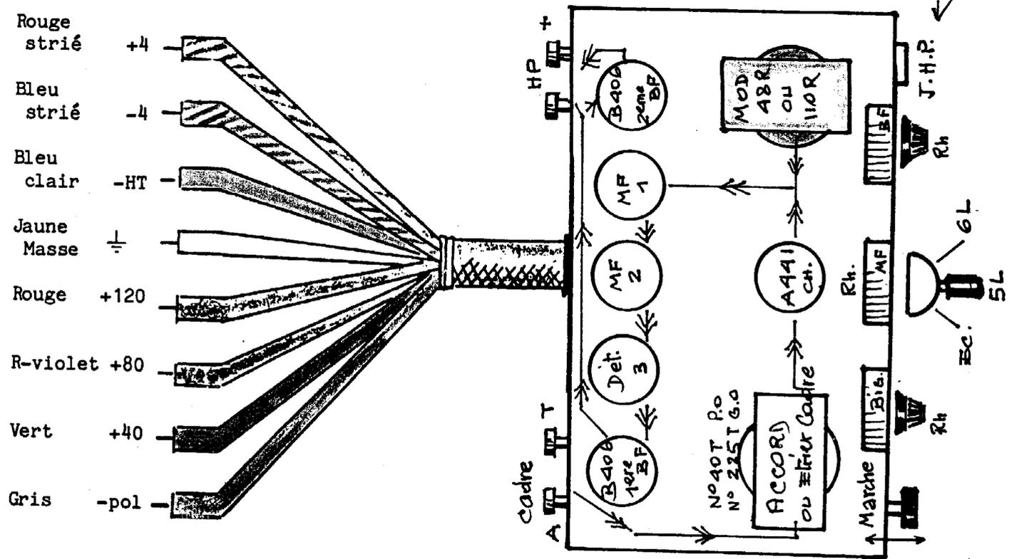
Dans ce récepteur, -HT et -4 sont reliés à l'intérieur, avec lors de la mise en marche. On peut relier +80 et +120 lors d'une seule source HT+.
