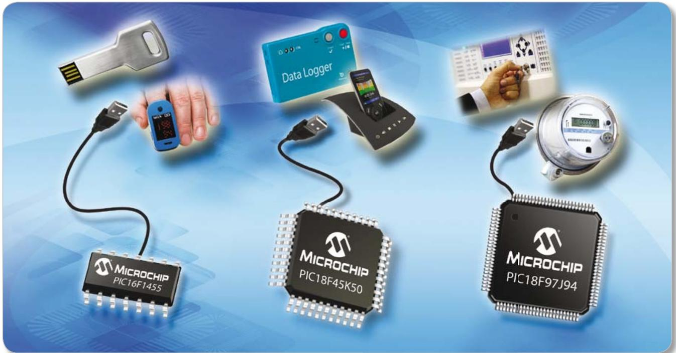
**Les microcontrôleurs USB les plus petits et les plus économiques de Microchip sont dotés de 14 broches et existent jusqu'à 100 broches et sont les premiers microcontrôleurs 8 bits à intégrer sur une seule et unique puce le pilotage d'écrans LCD, un module horloge calendrier temps-réel avec entrée batterie de secours et l'USB.**
