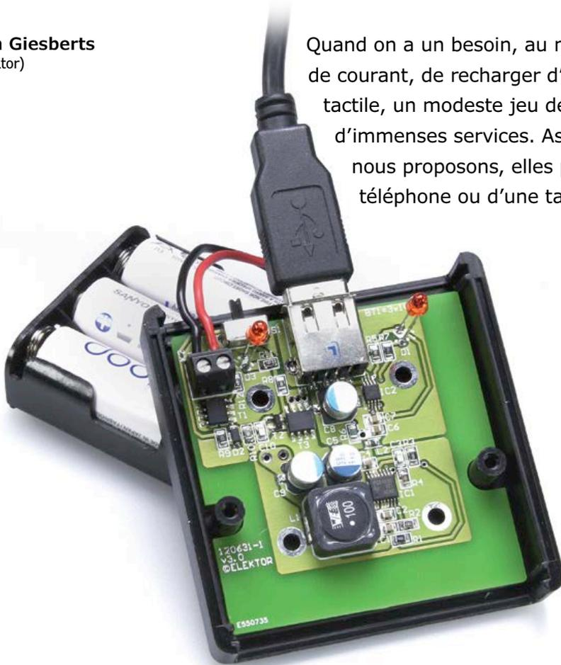
Ce pack de puissance est donc composé d'un jeu de batteries NiMH courantes et d'un chargeur.
