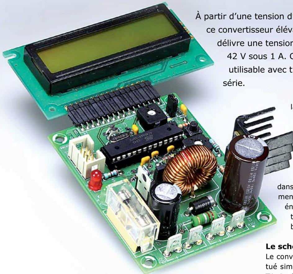
À partir d'une tension d'entrée comprise entre 8 et 16 V, ce convertisseur élévateur piloté par microcontrôleur délivre une tension de sortie qui peut atteindre 42 V sous 1 A. Cela en fait un chargeur mobile utilisable avec trois accumulateurs de 12 V en série.
