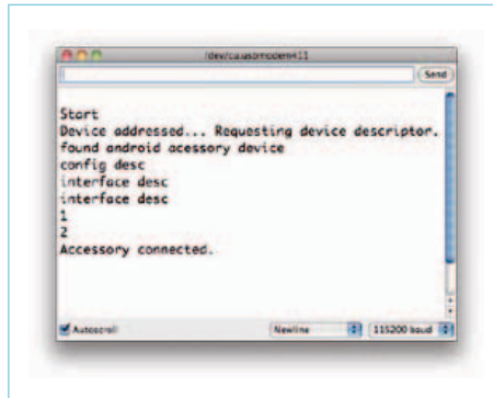
Figure 3. Capture d'écran du moniteur de port série lors de la connexion d'un appareil Android à l'Arduino Mega ADK.
