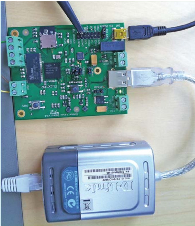
Figure 9. Un adaptateur USB/LAN pour transformer la carte en interface réseau.
