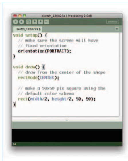
Figure 8. Capture d'écran de Processing en mode Android ; vous remarquerez le bouton de sélection de mode dans le coin supérieur gauche.
